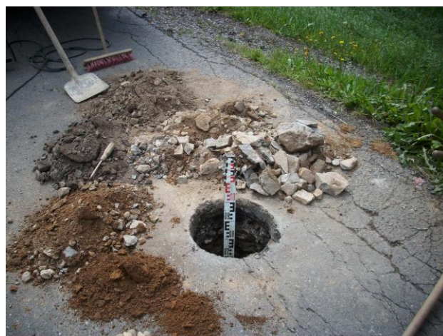
Schurf 11 (Station 2+615), Steine/Packlager von 45-65 cm
