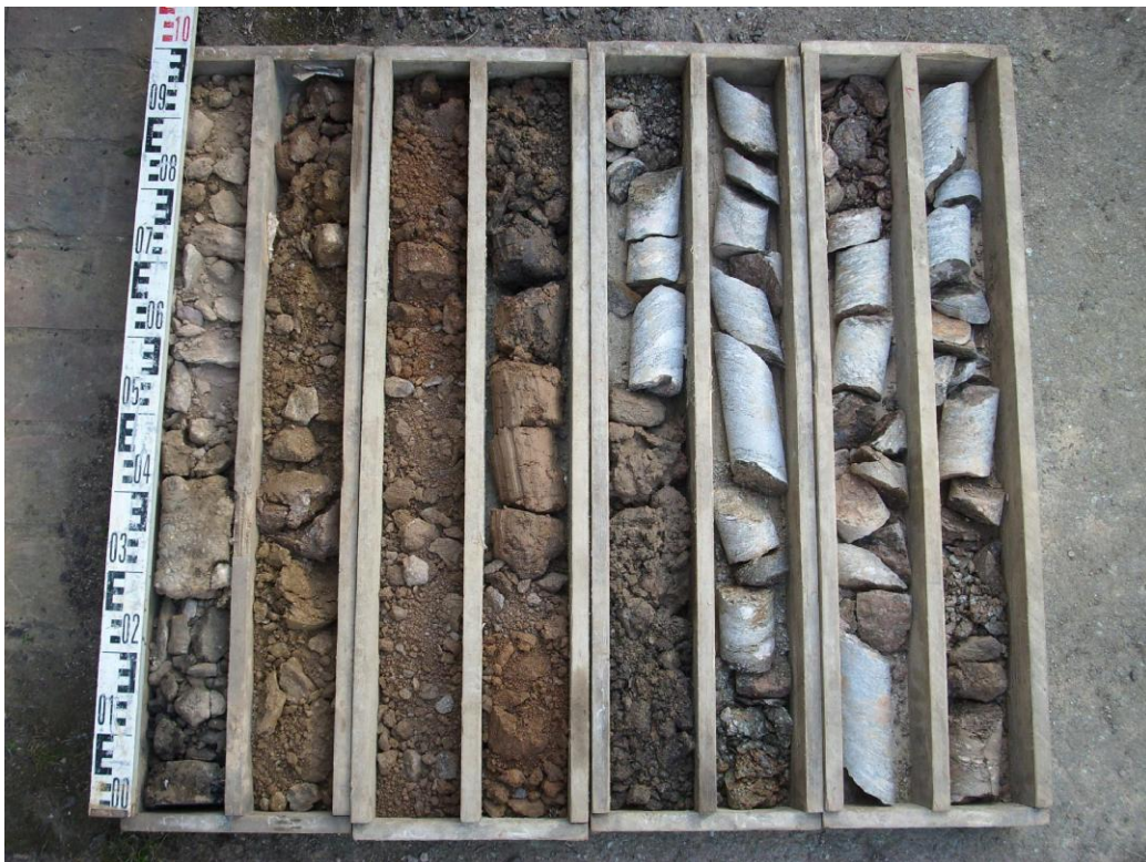
BK 1: Rotationskernbohrung, Endteufe: 8,0 m
