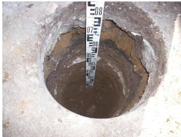
Schurf 13 (Station 2+820), Steine/Packlager von 22-30 cm
