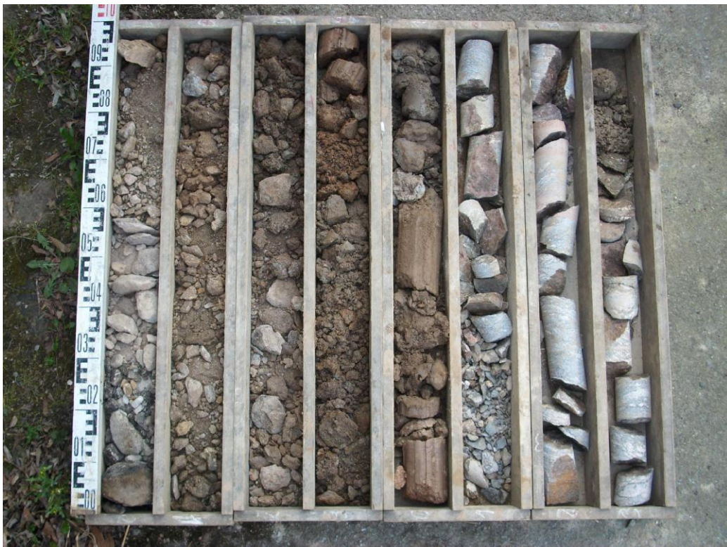
BK 2: Rotationskernbohrung, Endteufe: 8,0 m
