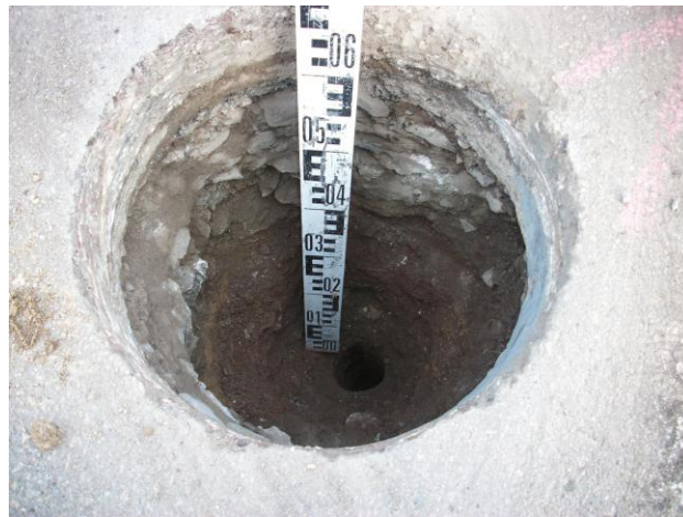
Schurf 1 (Station 1+614), Steine/Packlager von 30-40 cm
