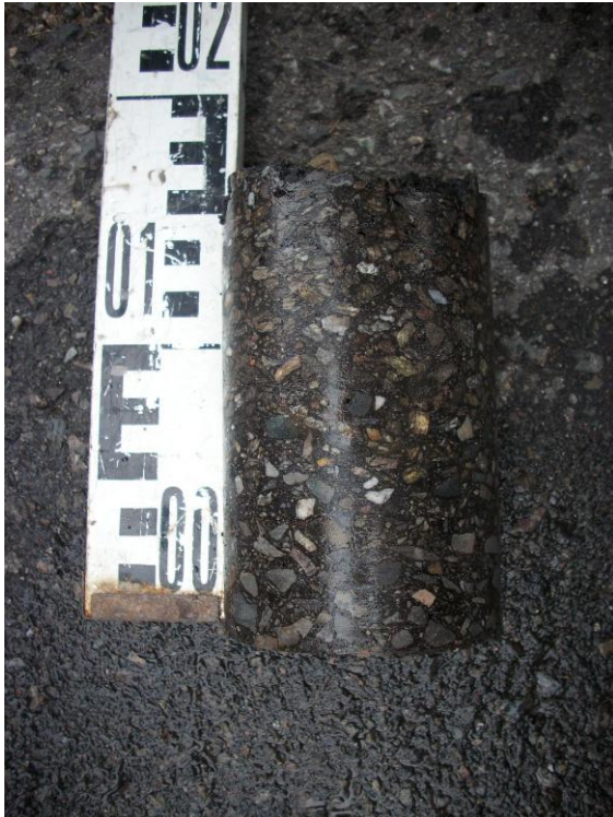
KB 8a: Gesamtstärke 15 cm (2 Schichten), Bohrung über Abwasserkanal
