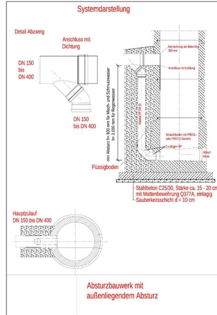
Anbindung außenliegender Untersturz bei Zulauf DN150 bis DN400, gem. TRL für den Neubau und die Erneuerung von Freispiegelkanälen - WAD
