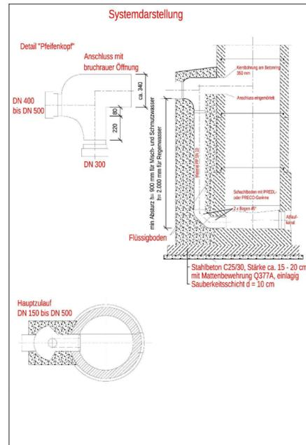
Anbindung außenliegender Untersturz bei Zulauf DN400 bis DN500, gem. TRL für den Neubau und die Erneuerung von Freispiegelkanälen - WAD
