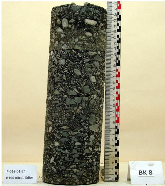
Oberkante im Foto an der Unterseite des Bohrkerns (Bohrkern steht auf dem Kopf!)
