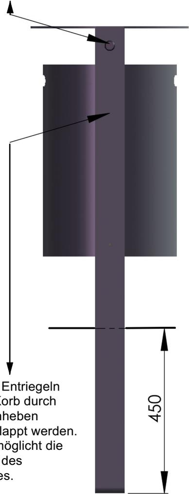
Nach dem Entriegeln kann der Korb durch leichtes Anheben herausgeklappt werden. Dieses ermöglicht die Entnahme des Innenkorbes.
