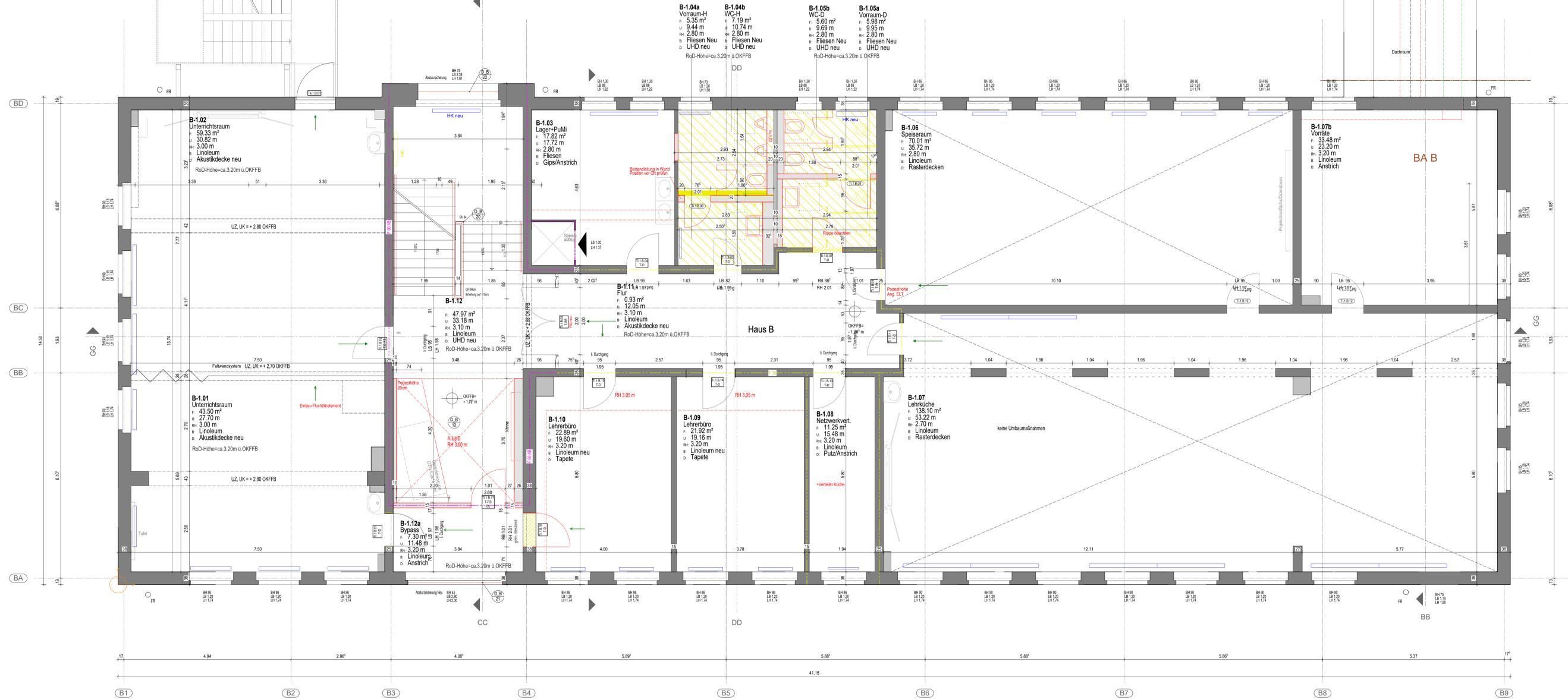
Die Stahlblechdecken im Haus A über dem KG, EG und 1.OG wurden als MENDEL-Decken in einer Stärke von h=25 cm ausgeführt. Jegliche Durchdringungen der Decken haben an bereits vorhandenen Öffnungen zu erfolgen bzw. sind neue Bohrungen vorher einzumessen! Eine Beschädigung der Decken durch Tragrippen ist zu vermeiden!
