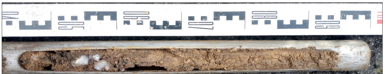
Bild 8: Sondeninhalt der RKS 10/24 mit künstlicher Auffüllung (0,50 m - 1,00 m), Foto: GIAB 20.02.2024
