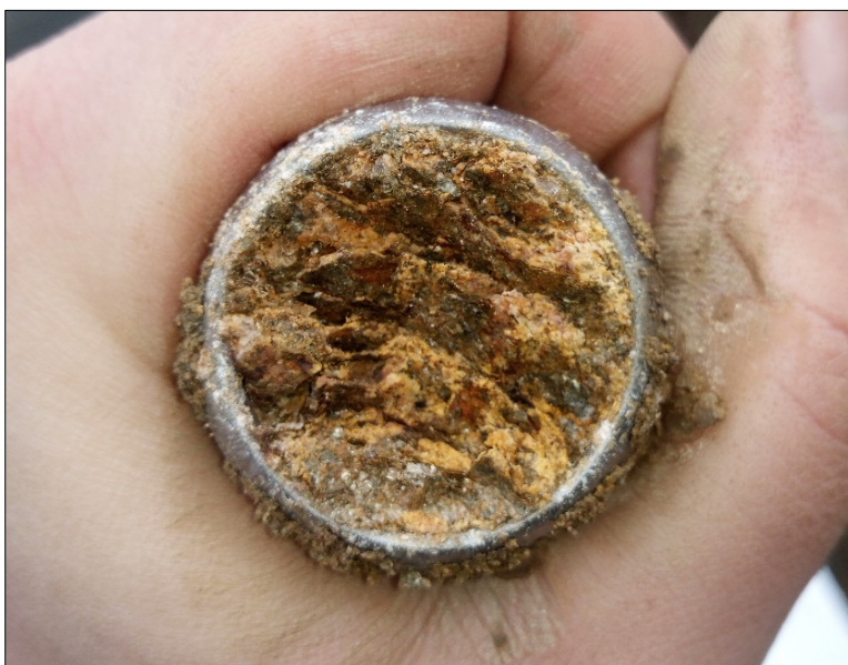
Bild 13: Ver- bis angewitterter Fels im Übergang zum unverwitterten Fels innerhalb der Sondenspitze der RKS 10/24 bei etwa 3,15 m u. GOK, Foto: GIAB 20.02.2024
