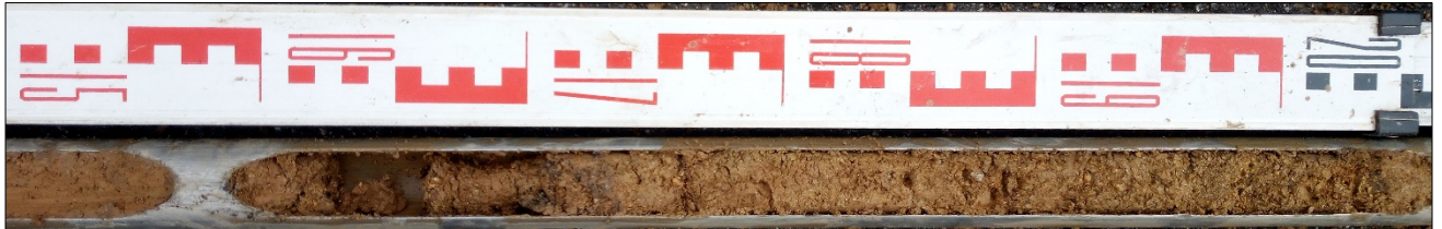
Bild 10: Sondeninhalt der RKS 10/24 mit Verwitterungslehm und Übergang zum Felsersatz des Gneises (1,50 m - 2,00 m), Foto: GIAB 20.02.2024
