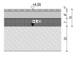
Fliesen Schnellzementestrich 65 mm CT-C30-F5-S65 PE Folie Trittschalldämmung 30 EPS 040 DES sg  $(SD \le 30MN/m^3 c \le 2mm)$ 40 Dämmung EPS unter schw. Estrich und Trittschalldämmung, DEO dm 220 mm Stahlbetondecke gem. Statik
