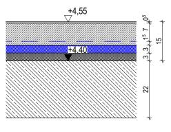
Kautschukbelag Schnellzement-Heizestrich CT-C30-F5-S85-H70 15 mm Heizrohre **Tackerplatte** 30 mm (mit integrierter Trittschalldämmung SD≤30MN/m³) gem. HLS Planung Dämmung EPS unter schw. Estrich und Trittschalldämmung, DEO dm
