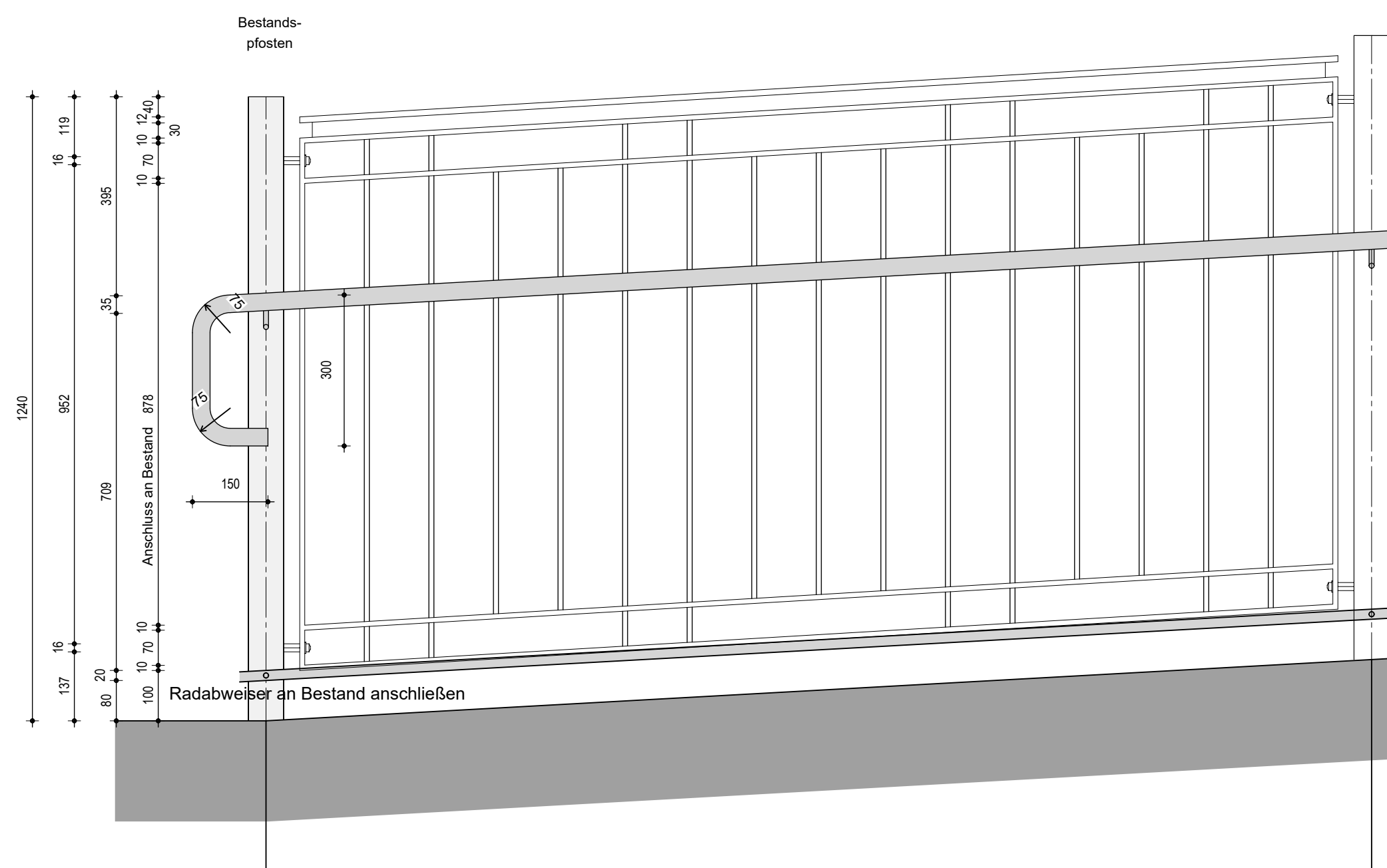
Detail - Füllstäbe Geländerfeld Normalgeländer Nord-Ostflügel 1:10
