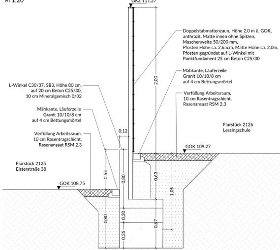
Schnitt B-B Stabmattenzaun und L-Winkel, Bereich Altwand M 1:20
