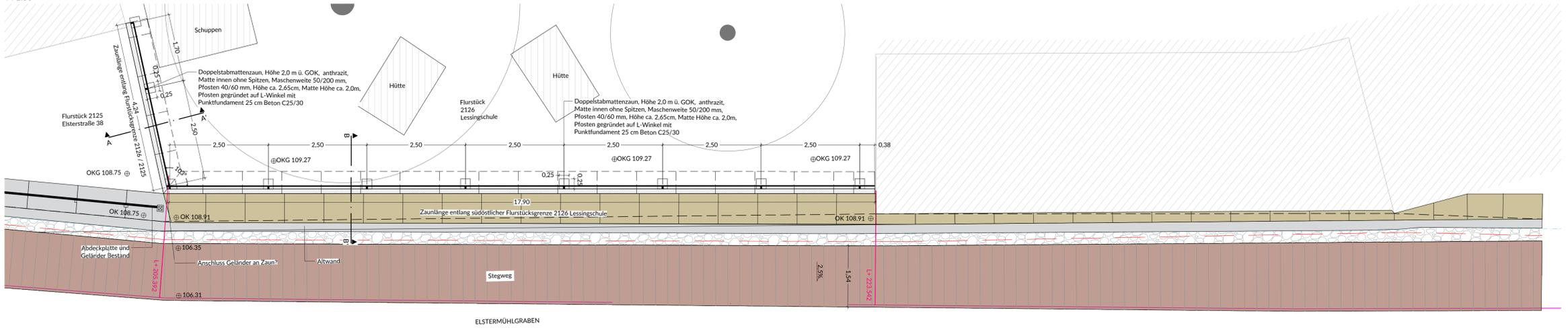
Aufsicht / Abwicklung Abdeckplatten Sandstein, neu, auf Altwand einschl. Nummerierung und Vermaßung M 1:50
