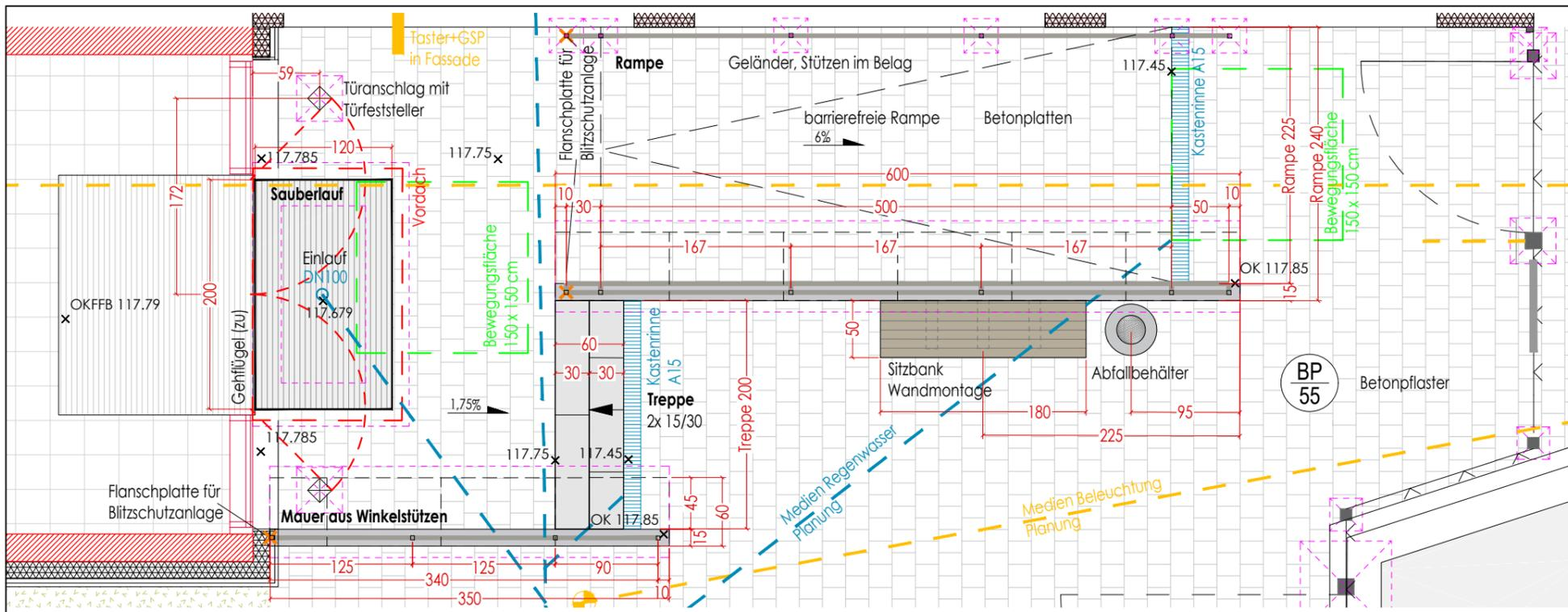
Grundriss Rampen- und Treppenanlage Haupteingang Nord M 1:50
