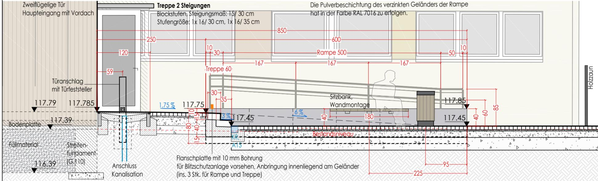
Schnittansicht Treppen- und Rampenanlage, Blick nach Süden M 1:50
