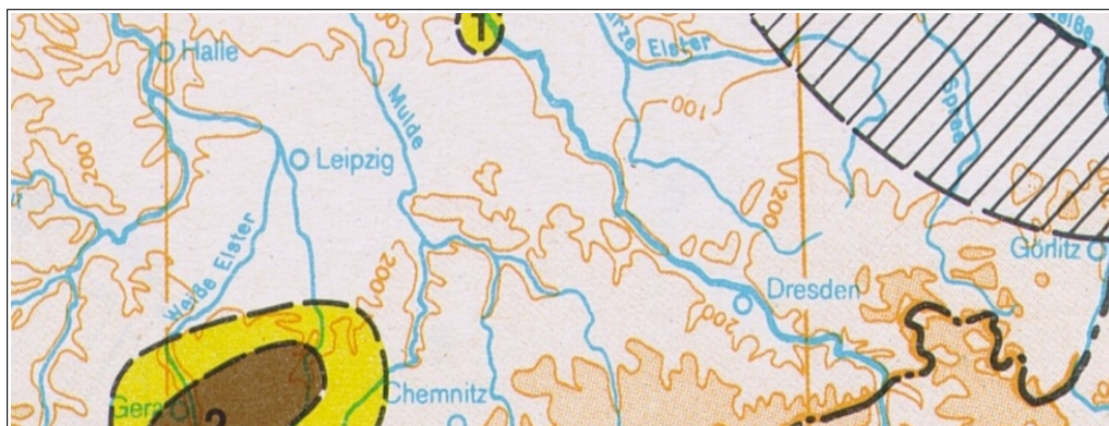
Abbildung: Karte zur Erdbebengefährdung [DIN EN 1998]
