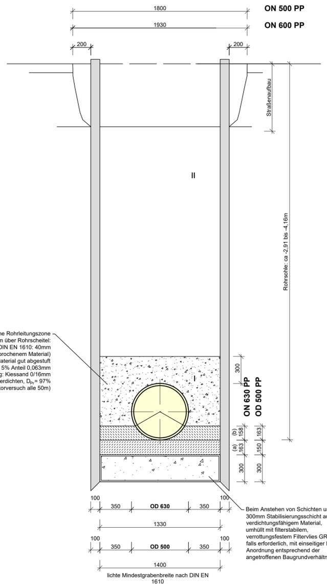
Beim Anstehen von Schichten und Grundwasser: 300mm Stabilisierungsschicht aus filterstabilem, verdichtungsfähigem Material, umhüllt mit filterstabilem, verrottungsfestem Filtervlies GRK 3, falls erforderlich, mit einseitiger Drainage, Anordnung entsprechend der angetroffenen Baugrundverhältnisse.
