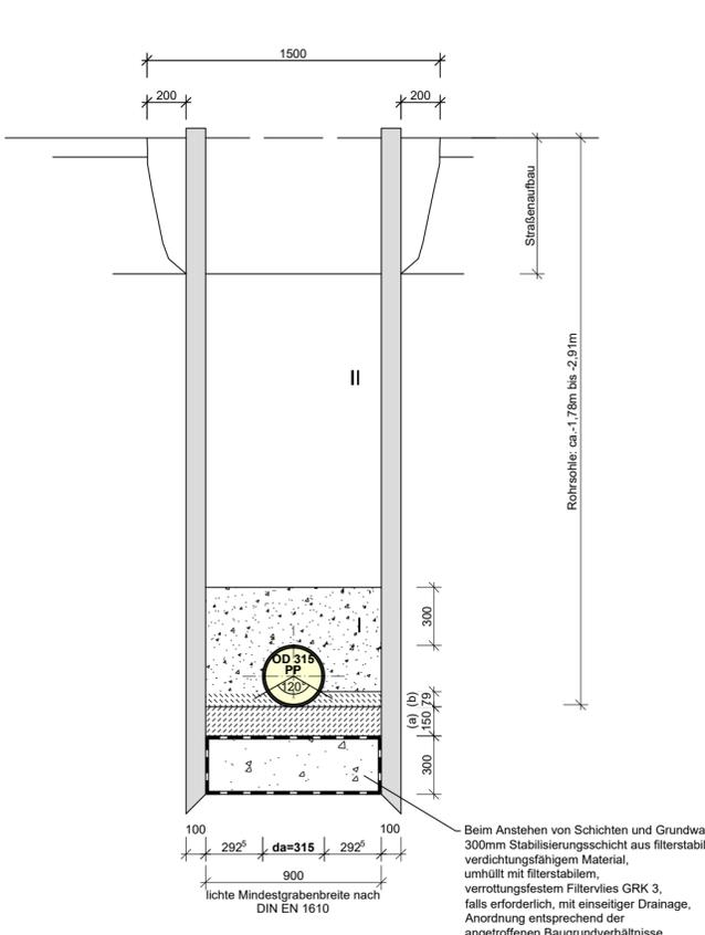
Beim Anstehen von Schichten und Grundwasser: 300mm Stabilisierungsschicht aus filterstabilem, verdichtungsfähigem Material, umhüllt mit filterstabilem, verrottungsfestem Filtervlies GRK 3, falls erforderlich, mit einseitiger Drainage, Anordnung entsprechend der angetroffenen Baugrundverhältnisse.
