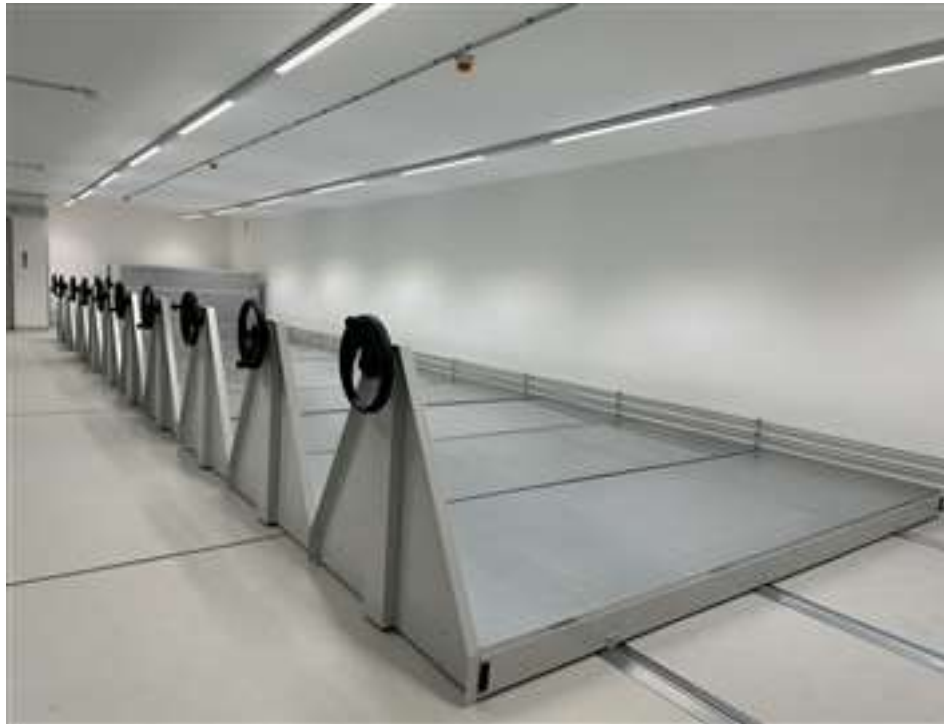
Foto 1: Beispielfoto eines Plattformwagens mit einer zusätzlichen Konstruktion zur Aussteifung des Kettenkastens / der Handradkonstruktion.
