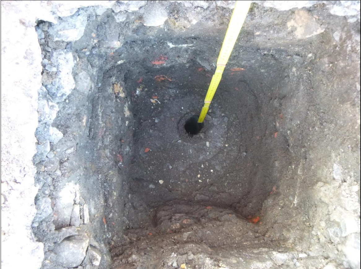
Aufbruch und Rammkernsondierung (A/RKS) 3 – Innenansicht Aufbruch
