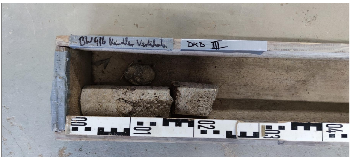
Diamantkernbohrungen (DKB) III – Ansicht Bohrkern
