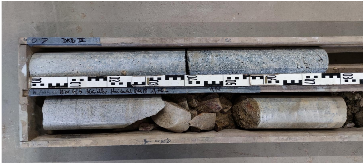
Diamantkernbohrungen (DKB) IV – Ansicht Bohrkern
