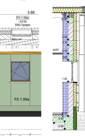
LV-Pos. 1.5 - 2 Stück: F0.1.09a+b Verglasung opal allgemein: Brüstungsriegel bei ca. 1,00 m passend zu Fenster mit Rohbau - BH 1,00m
