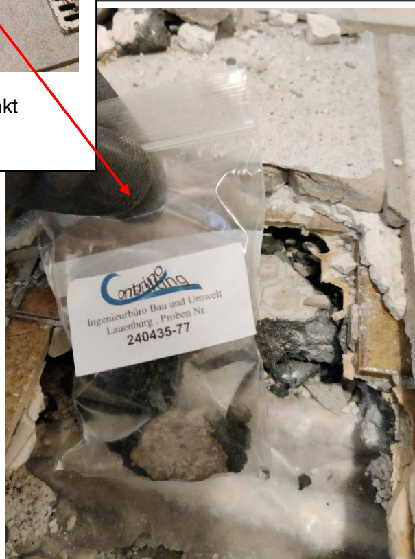
Probe 240435-77: Dünnbettmörtel asbesthaltig
