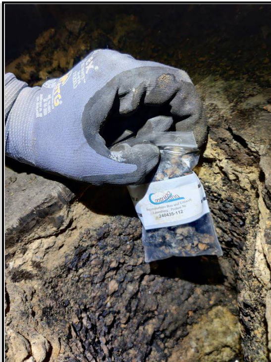
Bild 8: Keller, Fußboden PAK-haltige Korkdämmung
