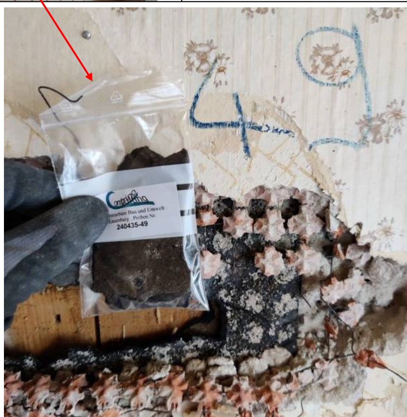
Probe 240435-49: Dachpappe, Feuchteschutz PAK-haltig
