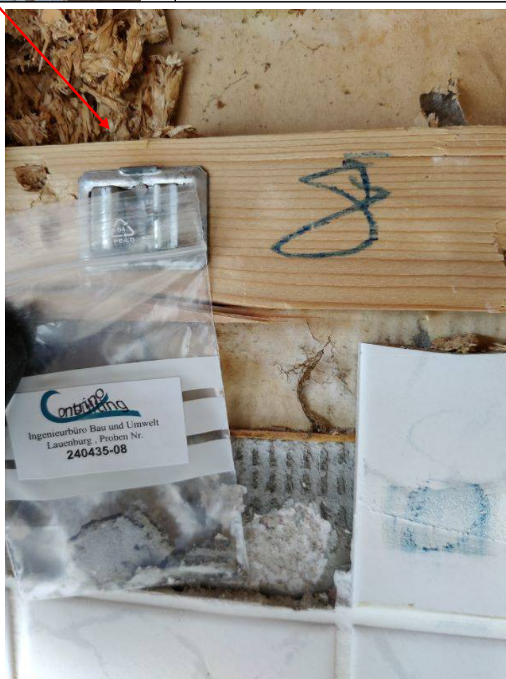
Probe 240435-08: Dünnbettmörtel (asbesthaltig)
