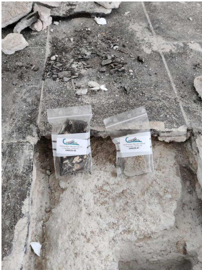
Probe 240435-40: Gussasphaltplatte Probe 240435-41: Estrich, Beton
