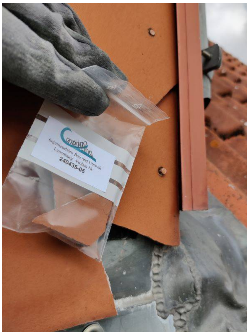
Gaubenverkleidung, Faserzementschindeln: kein Asbest nachgewiesen
