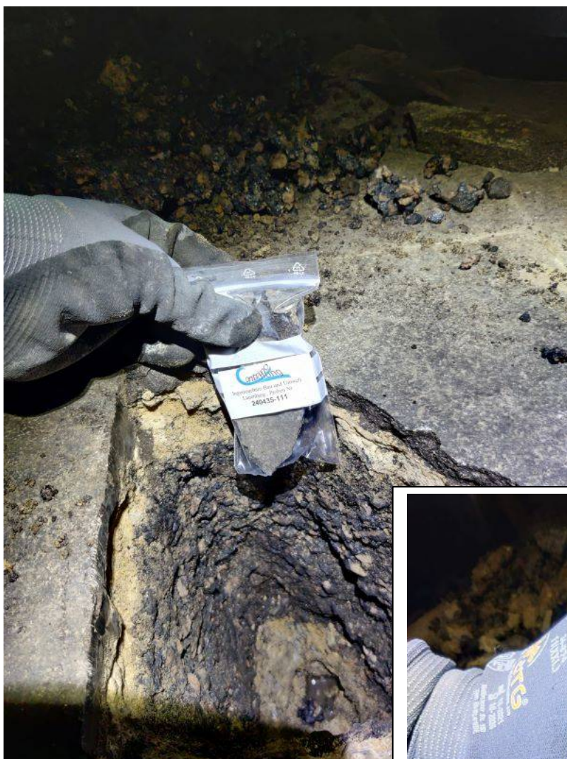
Keller, Fußboden: Probe 240435-111 Gussasphalt
