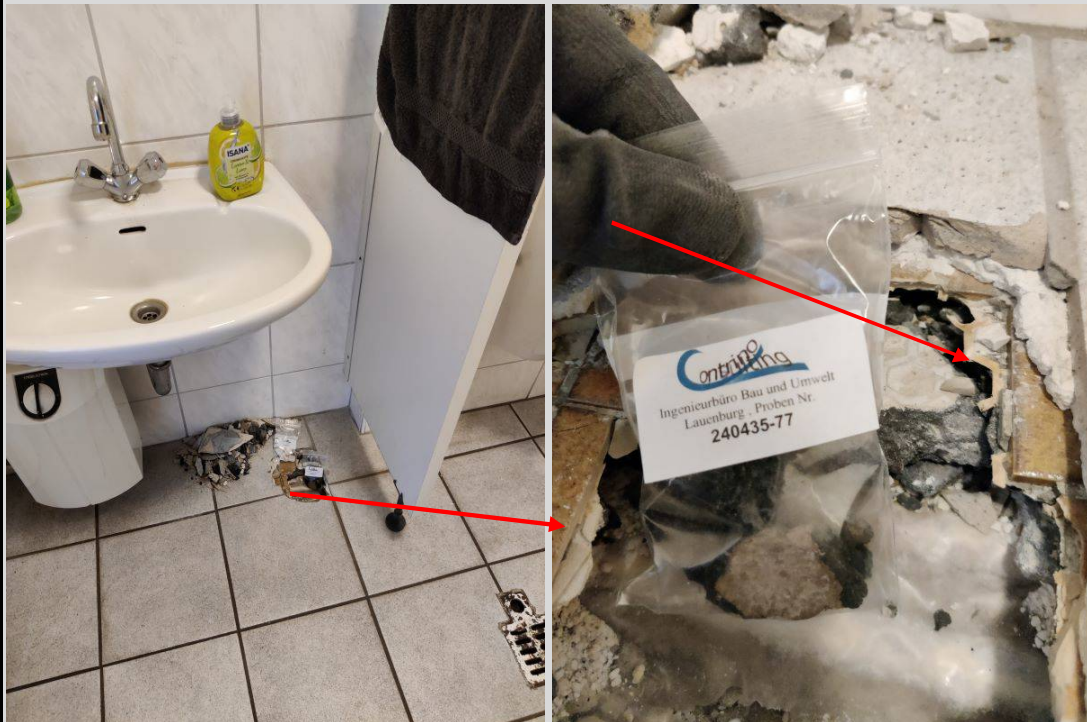
Bild 9+10: Feuerwehr, WC-Herren asbesthaltiger Dünnbettmörtel
