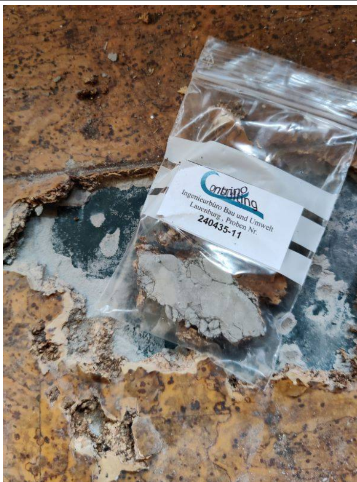
Küche, Fußboden: Probe 240435-11, Kork, Ausgleichsmasse (Ausgleichsmasse haftet am Korkoberbelag)
