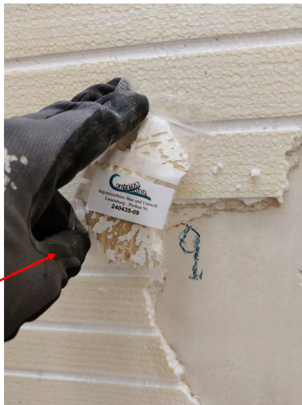
Probe 240435-09: Styropor (HBCD-haltig)
