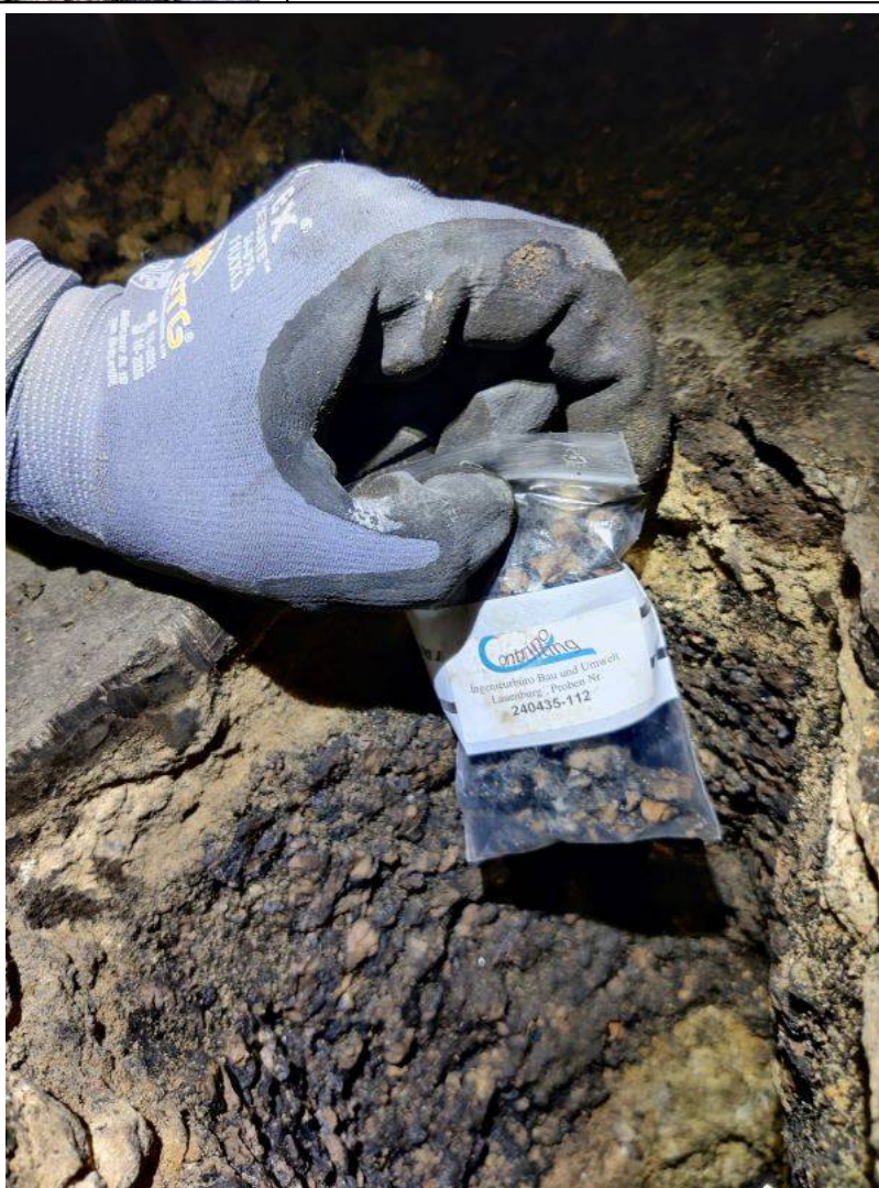
Keller, Fußboden: Probe 240435-113 Korkdämmung teerhaltig
