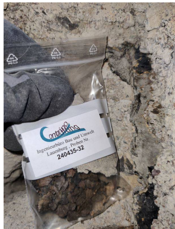
Probe 240435-32: Korkdämmung, Isolierpappe PAK-haltig
