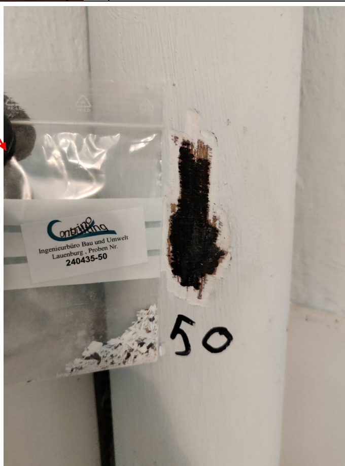
Probe 240435-50: Feuchteschutzbeschichtung PAK-haltig
