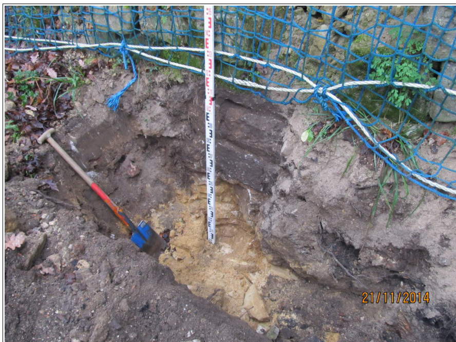
Abb. 4: Schurf 1 im Abschnitt der Einsturzstelle mit der Mauergründung
