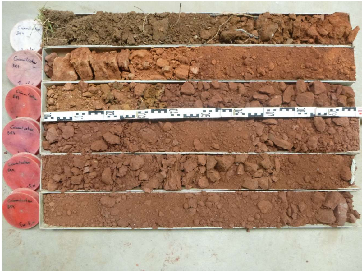
Rotationskernbohrung (KB) 4 – Bohrkern Gesamtansicht
