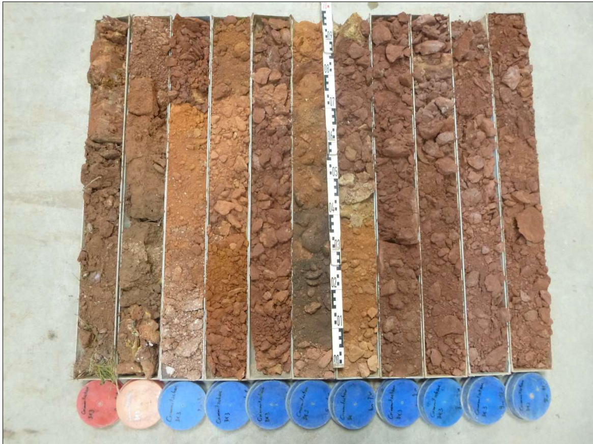
Rotationskernbohrung (KB) 3 – Bohrkern Gesamtansicht
