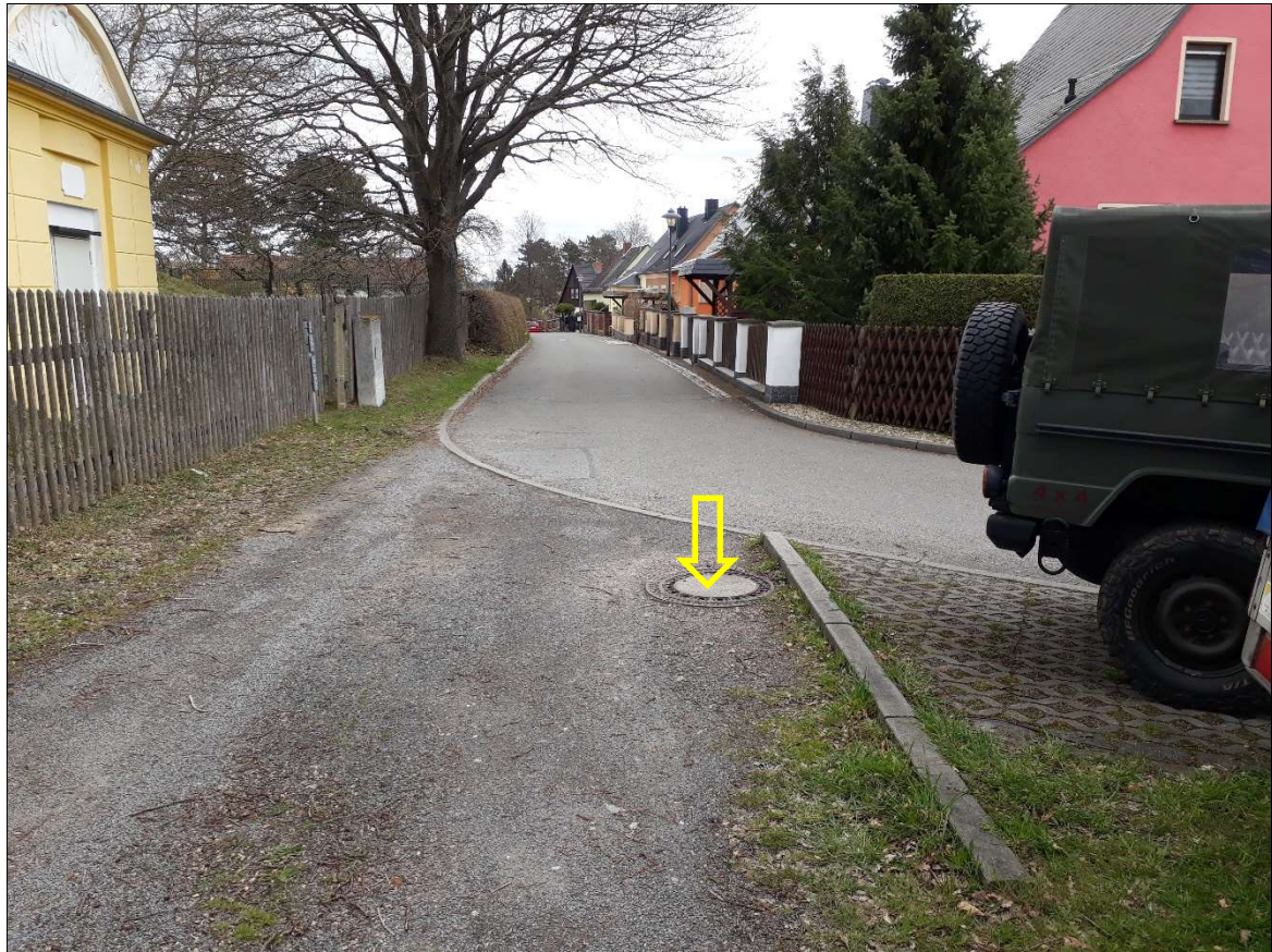
Höhenbezugspunkt HP / OK Deckel = 281,38 m DHHN2016
