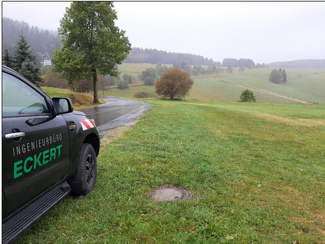
Bild 5: Höhenbezugspunkt (Schachtdeckel = 954,01 m HN76)
