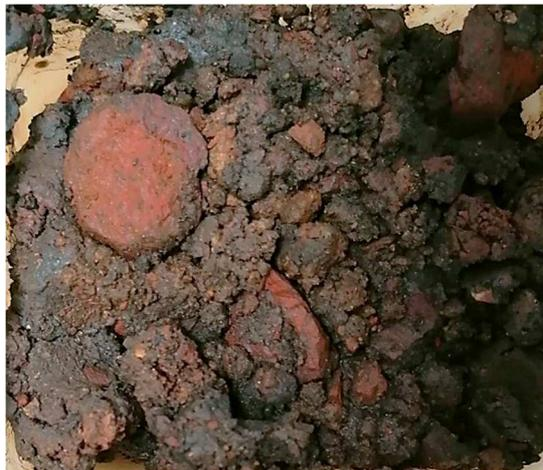
Bild 1: Strahlungsbelastete Bodenprobe mit Tailings, BS 8a aus 2,7m aus U 5
