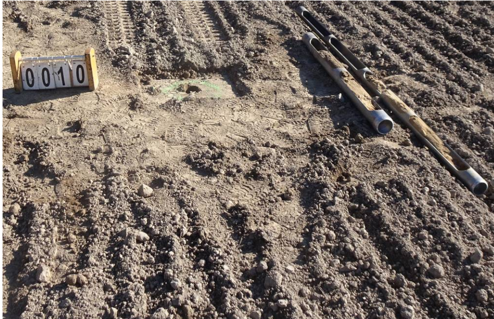
Bild 33: Entnahmestelle 10, Rammkernsondierung RKS 6 Umstrukturierung Trinkwasserleitung Thallwitz – Lossatal 1. BA, Bereich Feld Material der einzelnen Schichten ausgebaut
