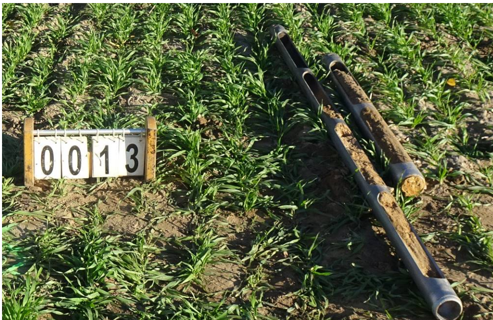
Bild 42: Entnahmestelle 13, Rammkernsondierung RKS 9 Umstrukturierung Trinkwasserleitung Thallwitz – Lossatal 1. BA, Bereich Feld Material der einzelnen Schichten ausgebaut
