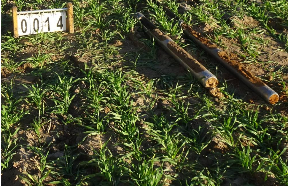
Bild 45: Entnahmestelle 14, Rammkernsondierung RKS 10 Umstrukturierung Trinkwasserleitung Thallwitz – Lossatal 1. BA, Bereich Feld Material der einzelnen Schichten ausgebaut
