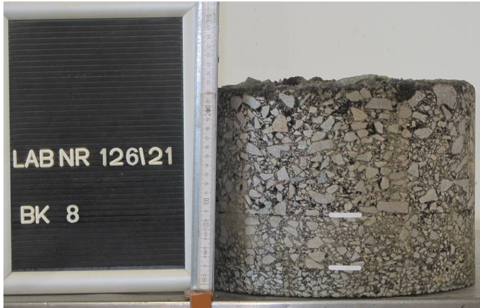
Bild 27: Entnahmestelle 8 Umstrukturierung Trinkwasserleitung Thallwitz – Lossatal 1. BA, Bereich Fahrbahn Detail Bohrkern Entnahmestelle 8, Ø 300 mm
