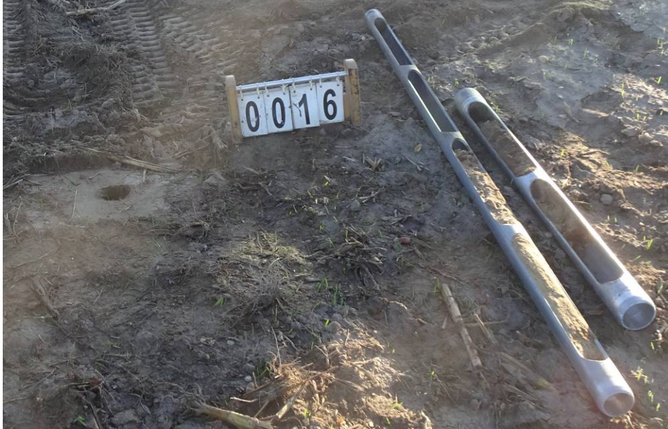
Bild 51: Entnahmestelle 16, Rammkernsondierung RKS 12 Umstrukturierung Trinkwasserleitung Thallwitz – Lossatal 1. BA, Bereich Feld Material der einzelnen Schichten ausgebaut
