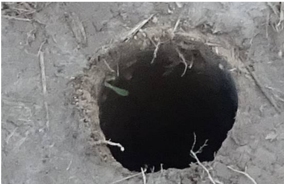
Bild 52: Entnahmestelle 16, Rammkernsondierung RKS 12 Umstrukturierung Trinkwasserleitung Thallwitz – Lossatal 1. BA, Bereich Feld Blick in Sondierstelle
