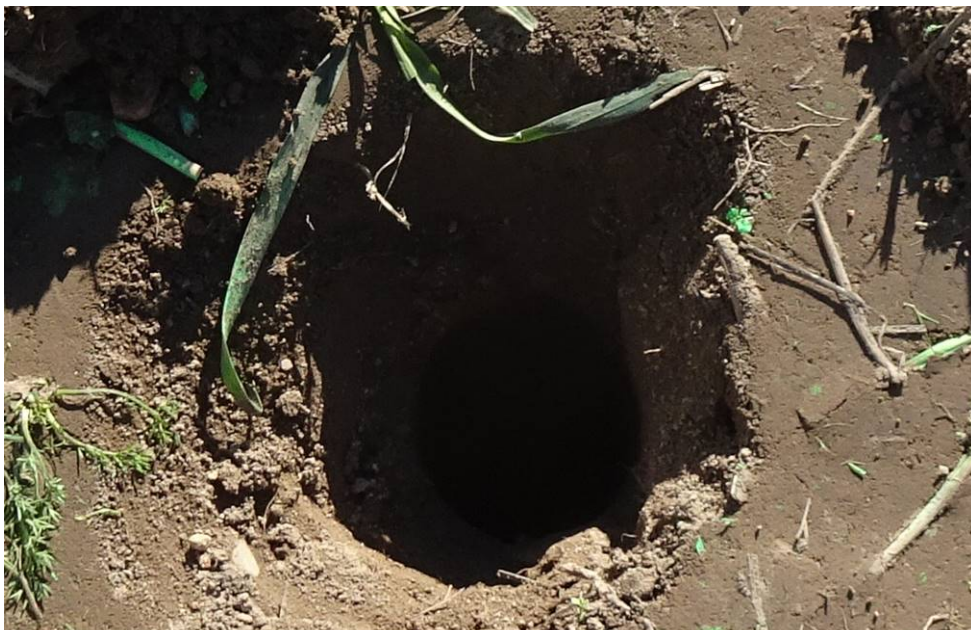
Bild 6: Entnahmestelle 2, Rammkernsondierung RKS 2 Umstrukturierung Trinkwasserleitung Thallwitz – Lossatal 1. BA, Bereich Feld Blick in Sondierstelle
