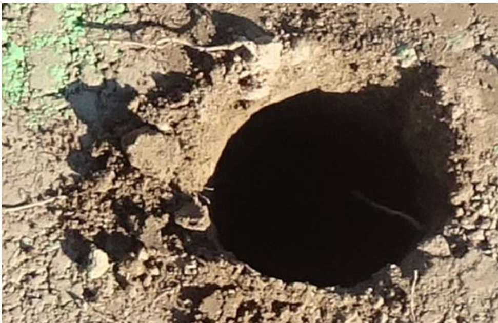
Bild 40: Entnahmestelle 12, Rammkernsondierung RKS 8 Umstrukturierung Trinkwasserleitung Thallwitz – Lossatal 1. BA, Bereich Feld Blick in Sondierstelle
