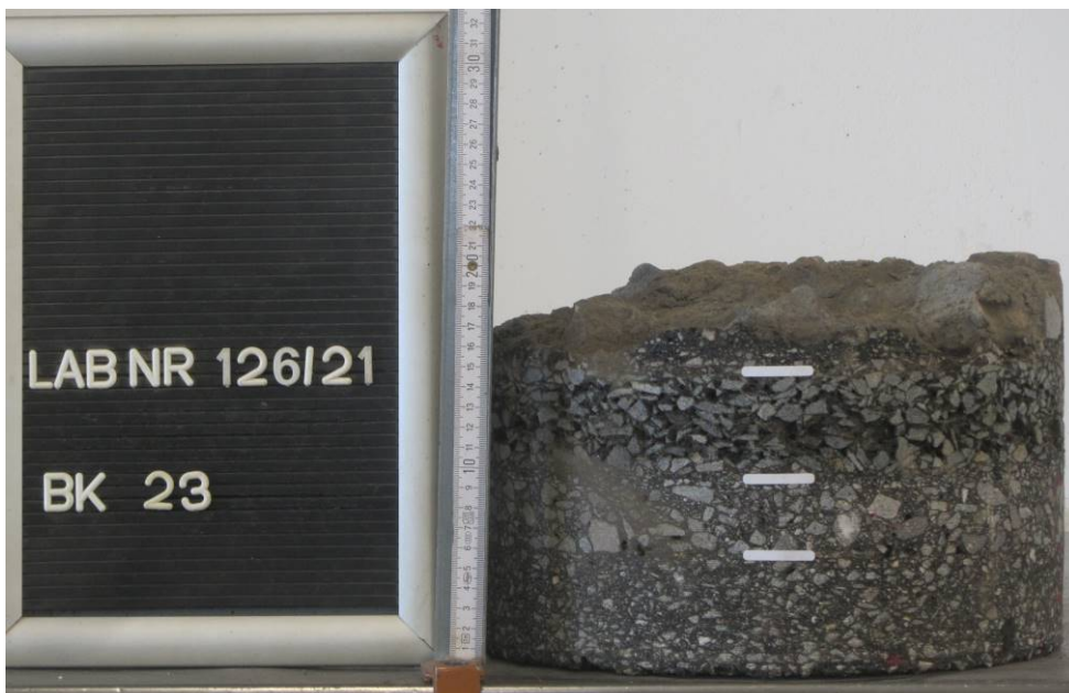
Bild 78: Entnahmestelle 23 Umstrukturierung Trinkwasserleitung Thallwitz – Lossatal 2. BA, Bereich Fahrbahn Detail Bohrkern Entnahmestelle 23, Ø 300 mm
