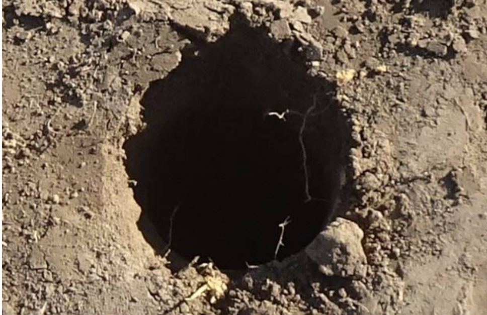
Bild 55: Entnahmestelle 17, Rammkernsondierung RKS 13 Umstrukturierung Trinkwasserleitung Thallwitz – Lossatal 1. BA, Bereich Feld Blick in Sondierstelle
