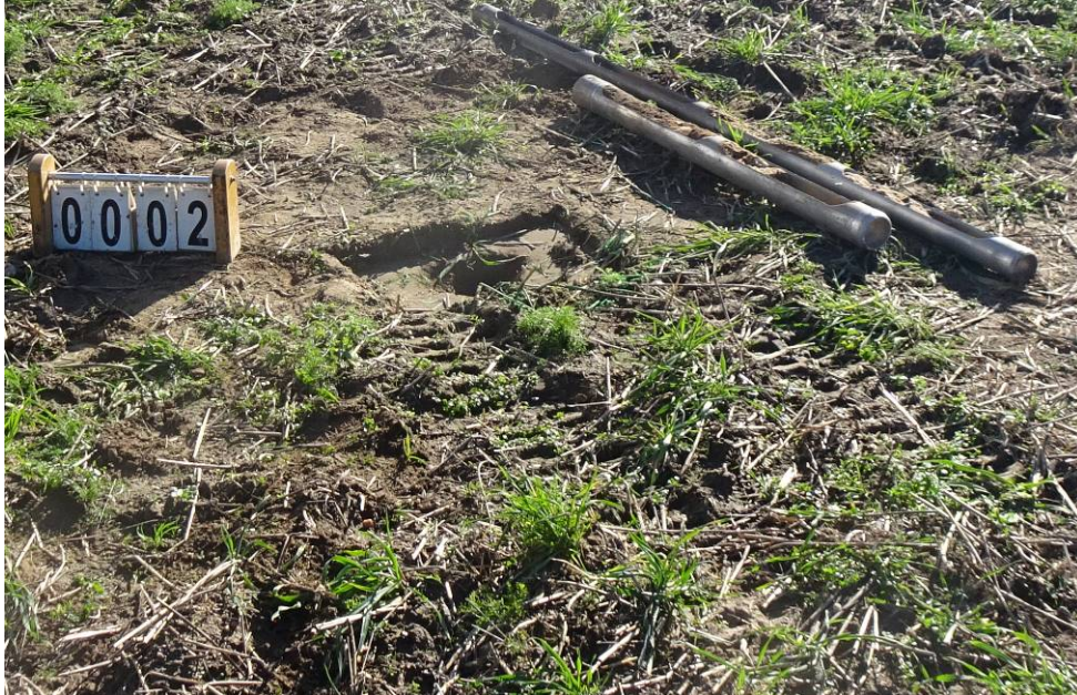
Bild 5: Entnahmestelle 2, Rammkernsondierung RKS 2 Umstrukturierung Trinkwasserleitung Thallwitz – Lossatal 1. BA, Bereich Feld Material der einzelnen Schichten ausgebaut
