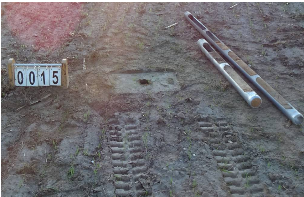
Bild 48: Entnahmestelle 15, Rammkernsondierung RKS 11 Umstrukturierung Trinkwasserleitung Thallwitz – Lossatal 1. BA, Bereich Feld Material der einzelnen Schichten ausgebaut
