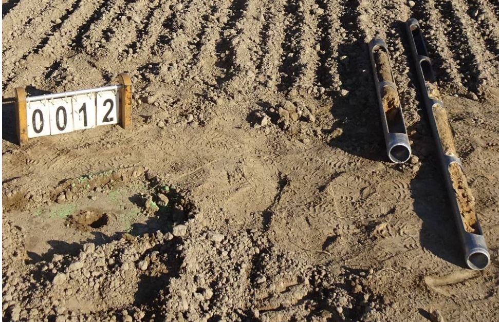
Bild 39: Entnahmestelle 12, Rammkernsondierung RKS 8 Umstrukturierung Trinkwasserleitung Thallwitz – Lossatal 1. BA, Bereich Feld Material der einzelnen Schichten ausgebaut
