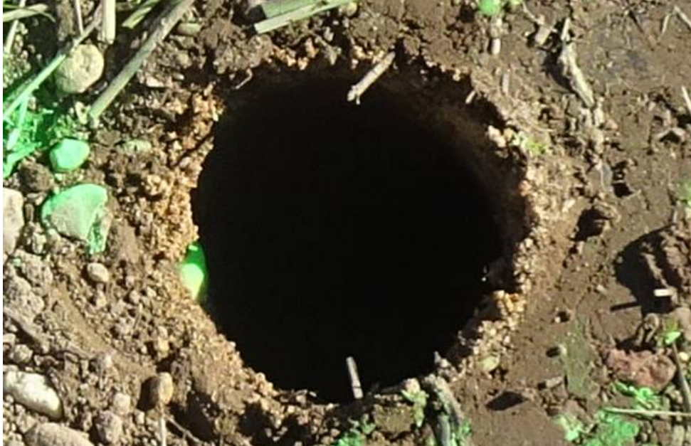
Bild 9: Entnahmestelle 3, Rammkernsondierung RKS 3 Umstrukturierung Trinkwasserleitung Thallwitz – Lossatal 1. BA, Bereich Feld Blick in Sondierstelle
