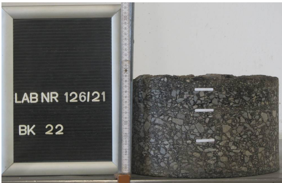
Bild 74: Entnahmestelle 22 Umstrukturierung Trinkwasserleitung Thallwitz – Lossatal 2. BA, Bereich Fahrbahn Detail Bohrkern Entnahmestelle 22, Ø 300 mm
