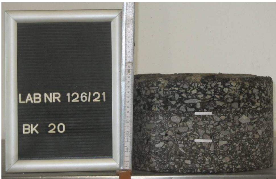
Bild 66: Entnahmestelle 20 Umstrukturierung Trinkwasserleitung Thallwitz – Lossatal 2. BA, Bereich Fahrbahn Detail Bohrkern Entnahmestelle 20, Ø 300 mm
