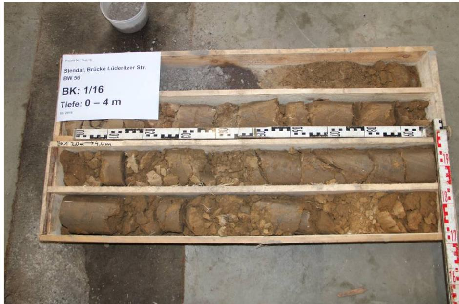
Abbildung 1: Bohrung BK 1, t = 0 – 4,0 m unter GOK
