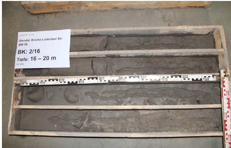
Abbildung 10: Bohrung BK 2,  $t = 16,0 - 20,0$  m unter GOK
