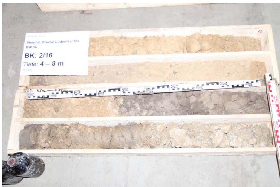
Abbildung 7: Bohrung BK 2, t = 4,0 – 8,0 m unter GOK
