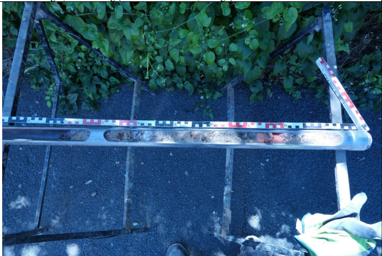
Kernbohrung 5, Rad- u. Gehweg, Auffüllung Dammkörper bis 2,20 m unter Ansatz, ganze Ziegelsteinlagen, bindiger Mischboden, Mörtel, Kohlengrus, locker gelagert
