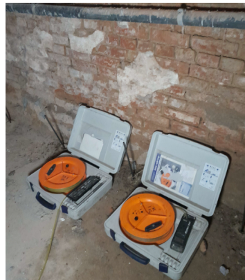
Abb. 9+10: Während der Injektionsarbeiten wurden die Ausweichsbewegung des Fußbodens über digitale Schlauchwaagen überwacht
