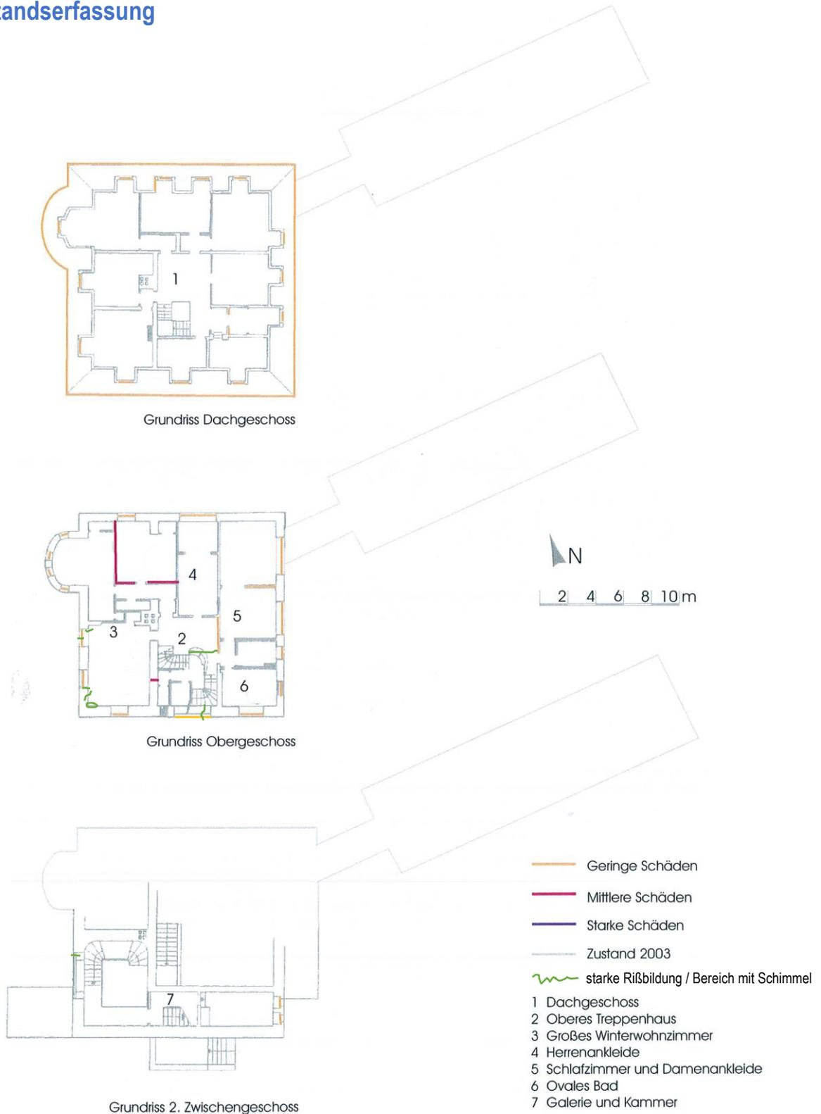
Abb. 12 Schadensanalyse – aktuelle Schadensanalyse, Stand 2018
