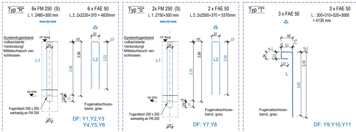
Fugenbänder: Elastomer DIN 7865 -1 -2, teilweise werkseitig vorgefertigte Systeme.
