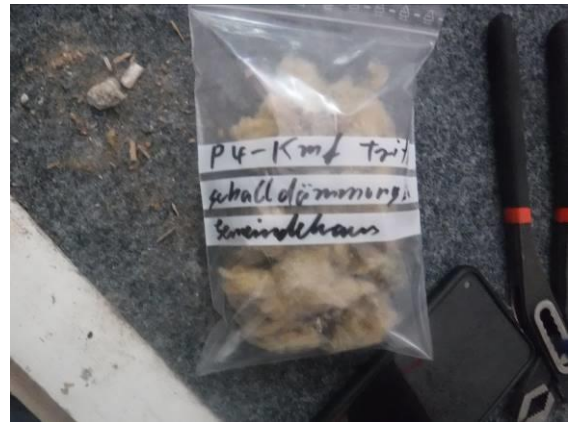
Foto 32: P4 – Trittschalldämmung EG
