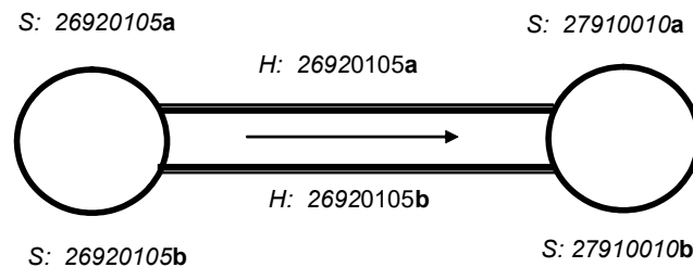
Abb. 2: Darstellung von mehreren an einem Schacht abgehenden Haltungen im Lageplan, inkl. Haltungs- und Schachtbezeichnung
