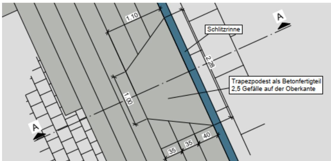
**Abb. 3: Detail Gestaltungselement Trapezpodest als Betonfertigteile**
