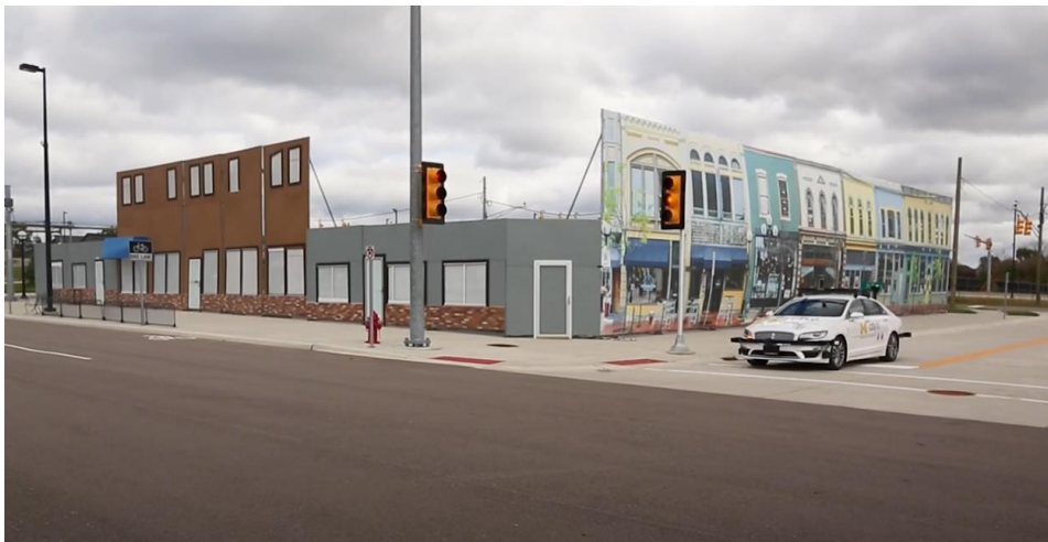
Abbildung 32: Versuchsaufbau Realszenarien mit mobilen Kulissenwänden, Ampeln etc. (Quelle: M-City)
