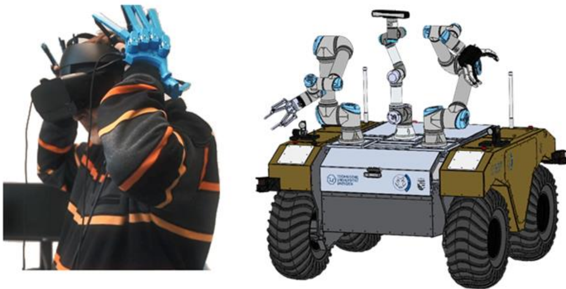
Abbildung 39: Telerobotik mit VR und haptischer Fernsteuerung des Greifers am Beispiel Sniffbot [Sniffbot].
