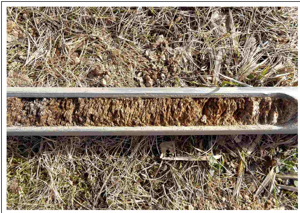
Foto 2: Detail aus Bohrung BS 1: Fels (blättrig-schuppiger Gneis, mäßiger hart)
