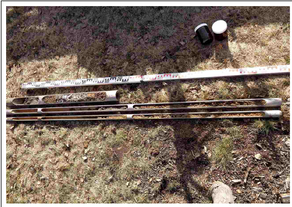
Foto 3: Bohrung BS 2, ausgelegt von links oben (0,0 m) nach rechts unten (- 3,8 m)
