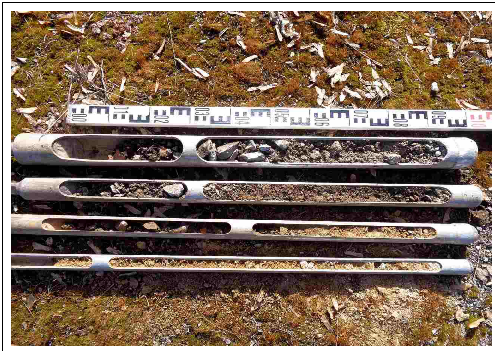
Foto 4: Bohrung BS 3, ausgelegt von links oben (0,0 m) nach rechts unten (- 4,0 m)
