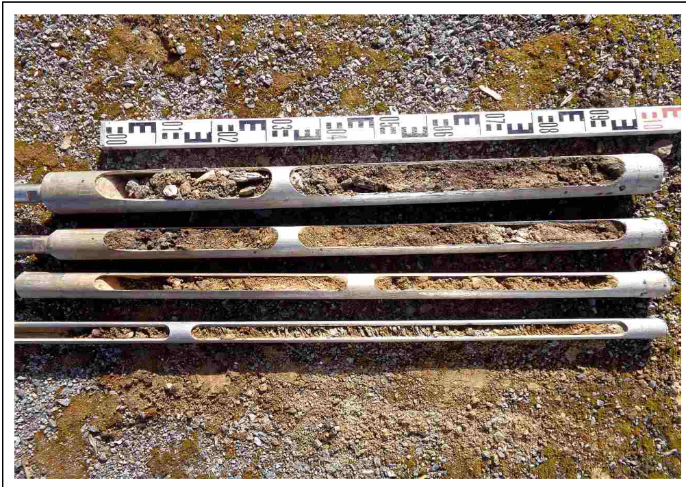
Foto 5: Bohrung BS 4, ausgelegt von links oben (0,0 m) nach rechts unten (- 3,8 m)
