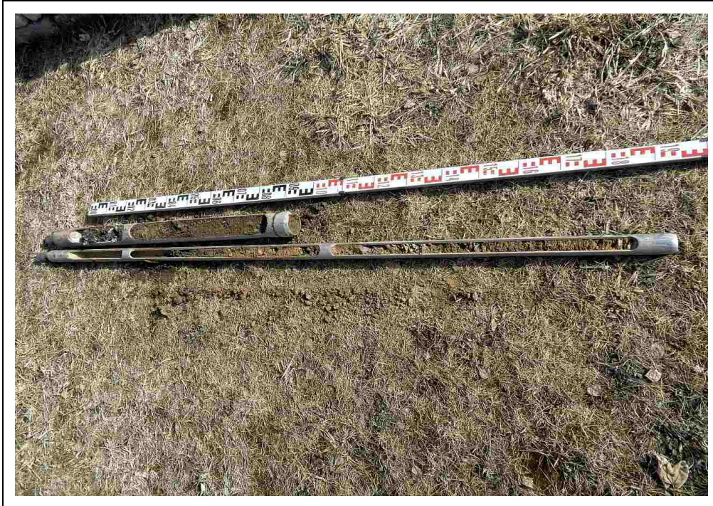
Foto 1: Bohrung BS 1, ausgelegt von links oben (0,0 m) nach rechts unten (- 3,0 m)
