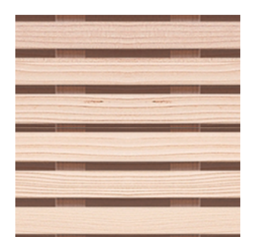
Echtholz-Akustikpaneele Weißtanne astrin, lebhaft Profil: 20 mm Leiste + 4 mm Fuge Akustik: absorbierend \alpha_w = bis 0,90
