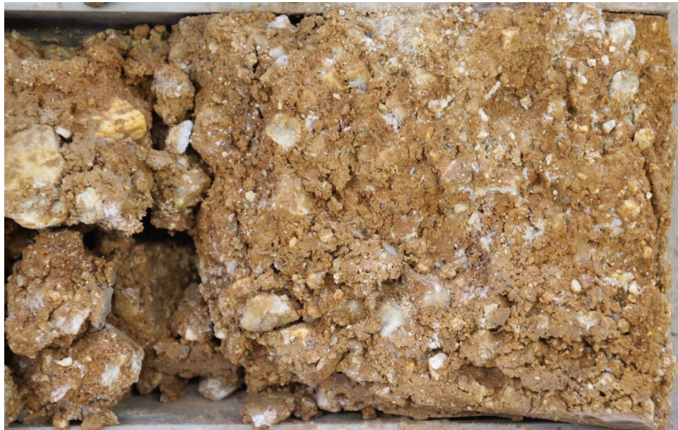
Foto 22: Bohrung BK 6/21 – Bohrkern 1,85...2,00 m/ Geschiebelehm
