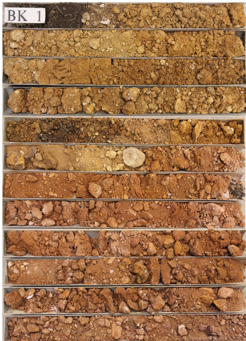
Foto 9: Bohrung BK 1/21 – Bohrkerne 0,00...12,00 m
