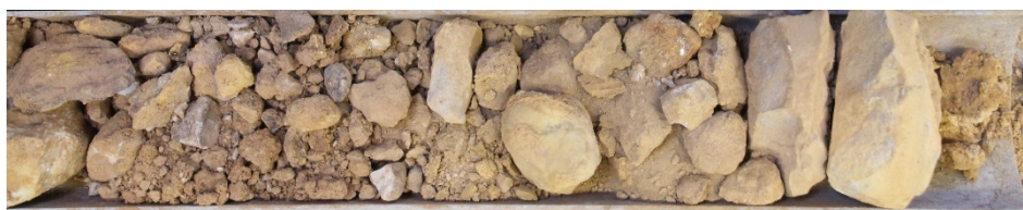
Foto 16: Bohrung BK 3/21 – Bohrkern 3,40...4,00 m/ Tertiäre Kiese und Steine
