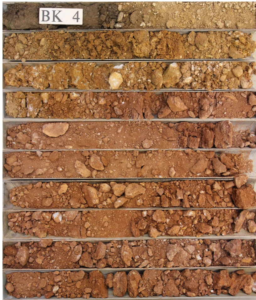
Foto 17: Bohrung BK 4/21 – Bohrkerne 0,00...10,00 m
