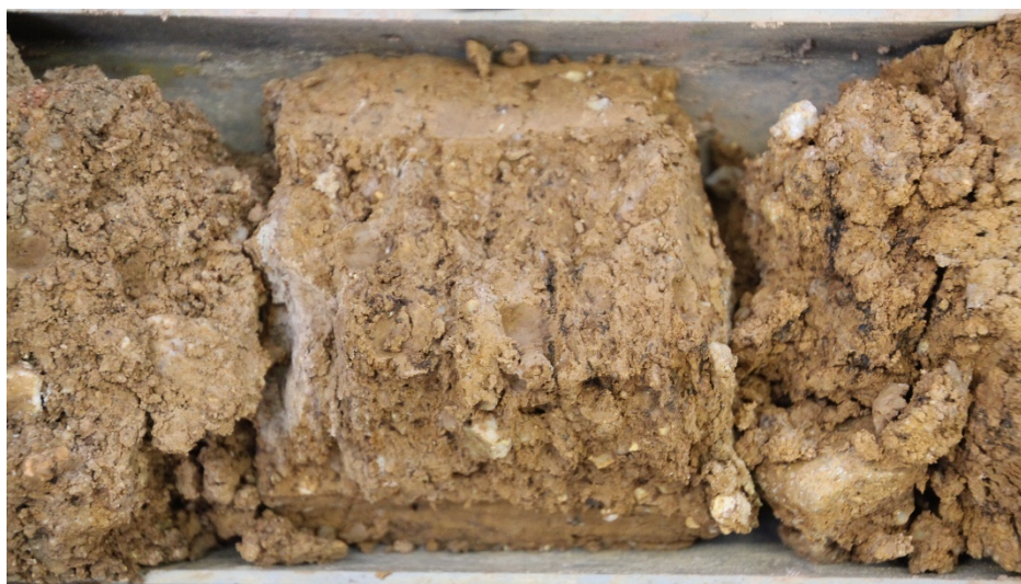
Foto 21: Bohrung BK 6/21 – Bohrkern 1,60...1,75 m/ Lößlehmartiger Gehängelehm
