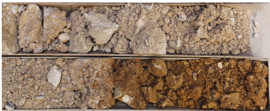
Foto 24: Bohrung BK 7/21 – Bohrkerne 2,45...3,00 und 3,45...4,00 m/ Hinterfüllung der Stützwand)
