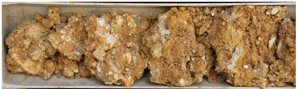
Foto 18: Bohrung BK 4/21 – Bohrkern 2,00...2,35 m/ Kiessande, stark schluffig (geschiebelehmartig)
