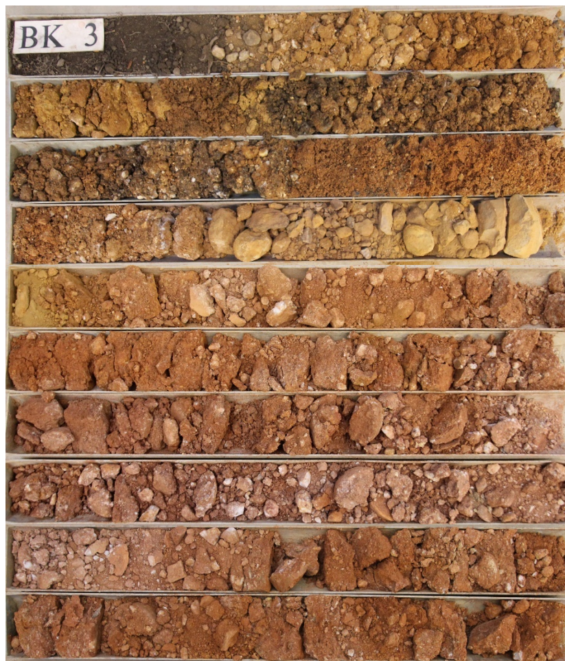
Foto 14: Bohrung BK 3/21 – Bohrkeren 0,00...10,00 m
