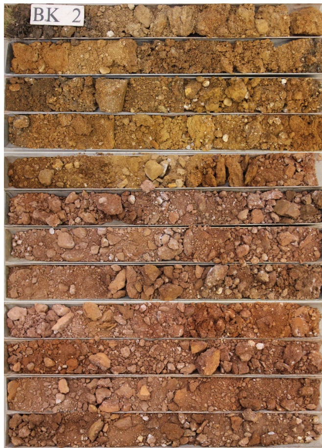
Foto 12: Bohrung BK 2/21 – Bohrkerne 0,00...12,00 m
