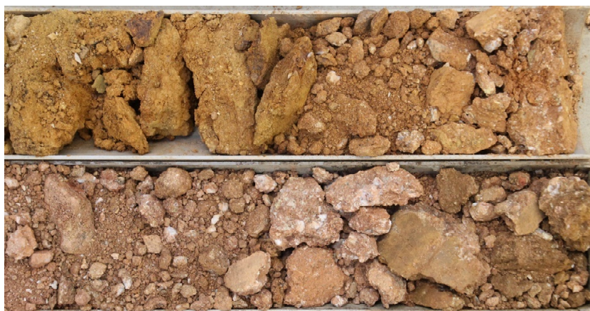
Foto 13: Bohrung BK 2/21 – Bohrkerne 4,65...5,00 und 5,65...6,00 m/ Tertiäre Kiessande (oben) und tertiäre Kiessande oder Konglomeratersatz (unten)
