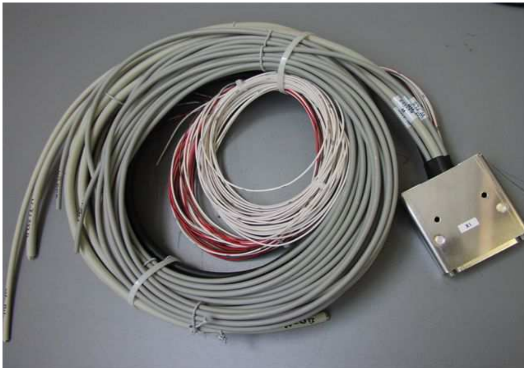
Übergabestecker 50pol. D-SUB mit fahrzeugseitiger Verdrahtung/Verkabelung (Bild4)
