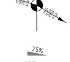
Neigungsbrechpunkt mit Angabe von Ausrundungshalbmesser, Bau-km,
