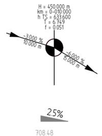
Neigungsbrechpunkt mit Angabe von Ausrundungshalbmesser, Bau-km, Höhe TS-Punkt, Tangentenlänge, Stichmaß, Längsneigung und Abstand zum nächsten Neigungsbrechpunkt
