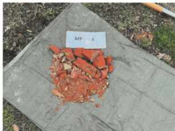
Abbildung 22 Mischprobe MP 3 Gussasphalt Schurf 1 und 4; Mischprobe MP 4 Betonkanal Putz mit Ziegel.
