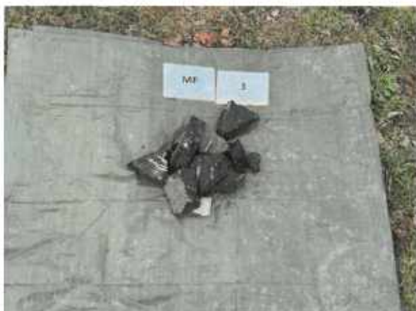
Abbildung 22 Mischprobe MP 3 Gussasphalt Schurf 1 und 4; Mischprobe MP 4 Betonkanal Putz mit Ziegel.
