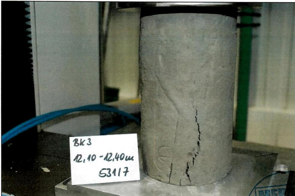
Bild 16: Bruchzustand Prüfkörper 531/7
