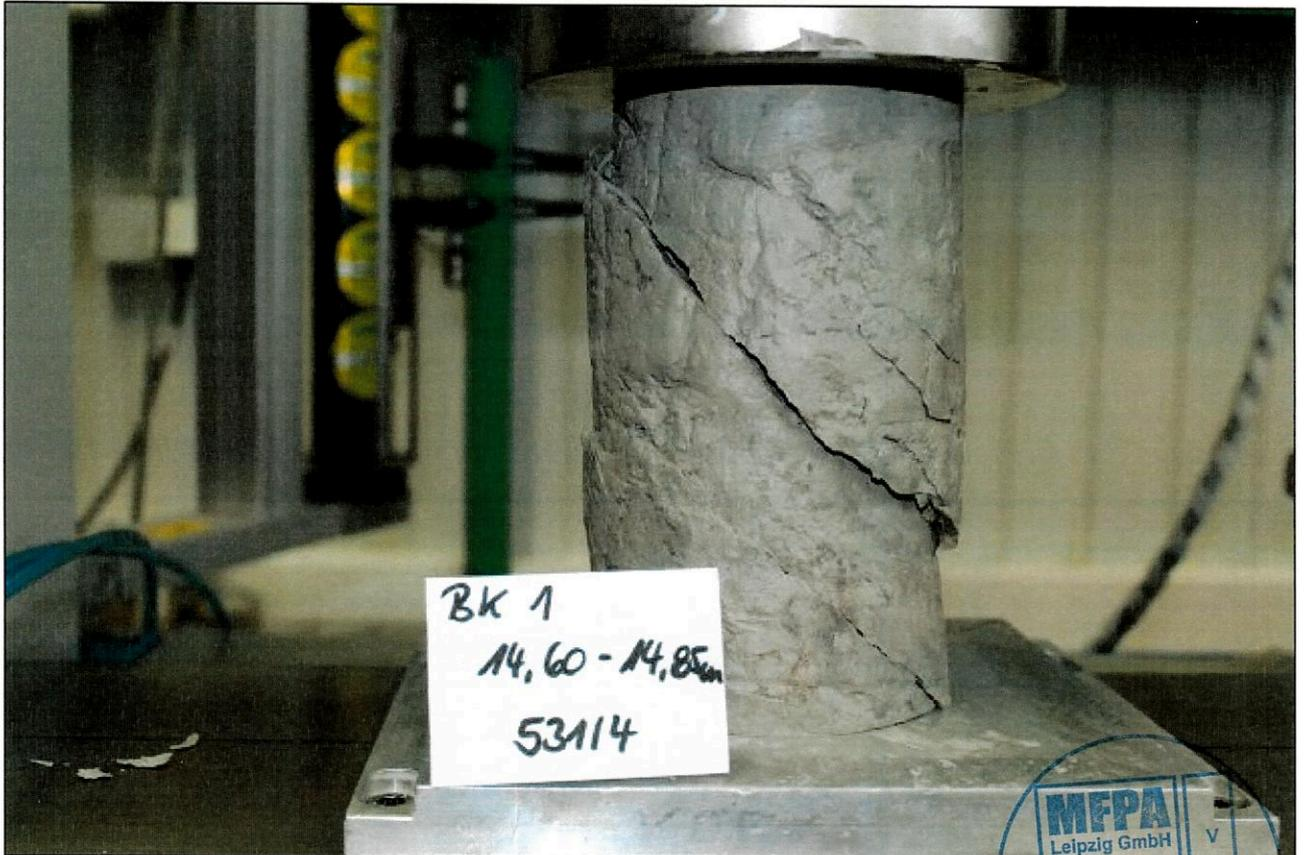
Bild 11: Bruchzustand Prüfkörper 531/4
