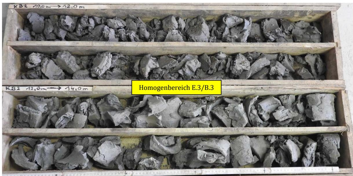
Abbildung 10: KB 2, 10. bis 14. Bohrmeter (Orientierung: ►, ▼)
