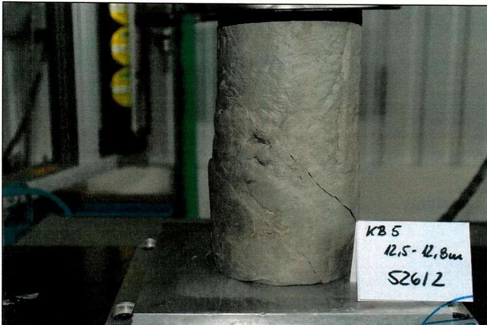
Bild 3: Bruchzustand Prüfkörper 526/2
