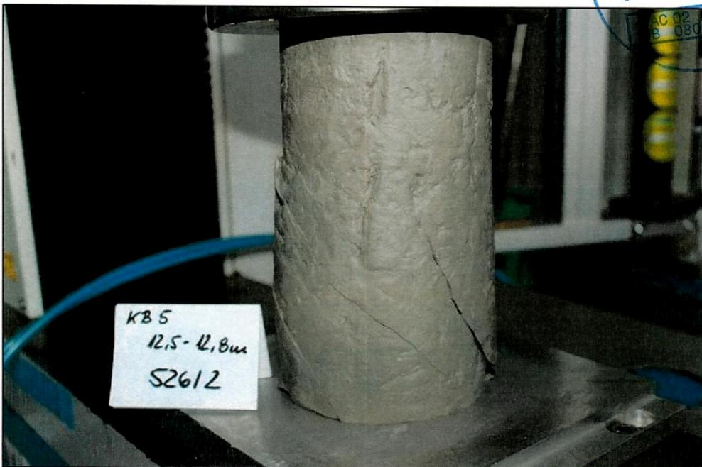
Bild 4: Bruchzustand Prüfkörper 526/2
