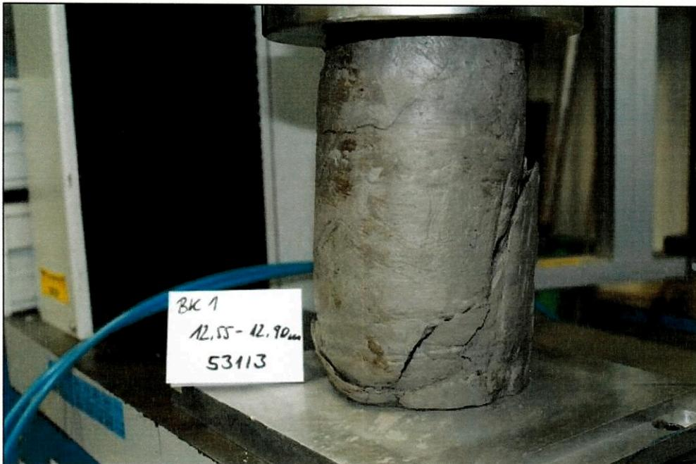
Bild 9: Bruchzustand Prüfkörper 531/3
