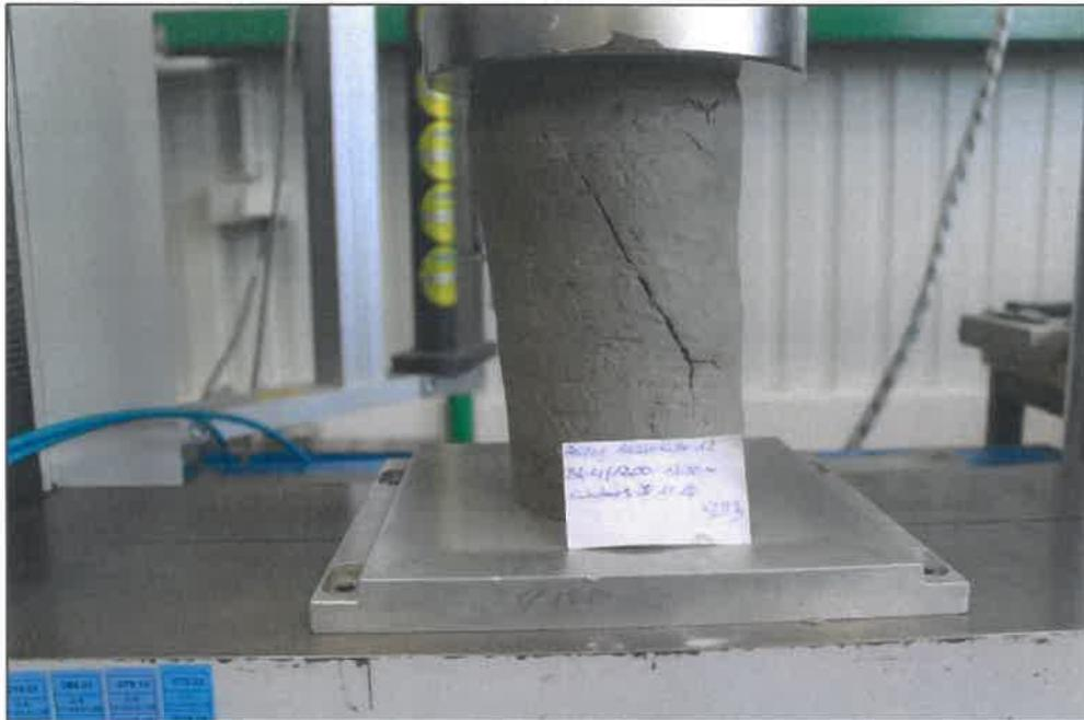
Bild 3: Bruchzustand Prüfkörper 523/3
