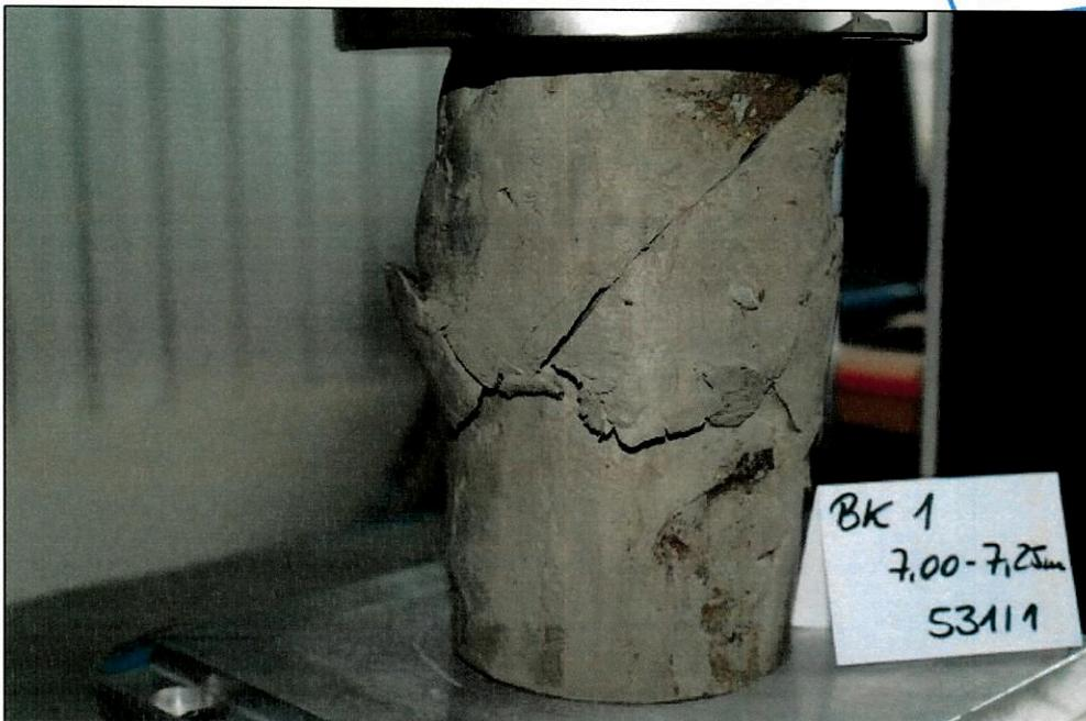
Bild 6: Bruchzustand Prüfkörper 531/1
