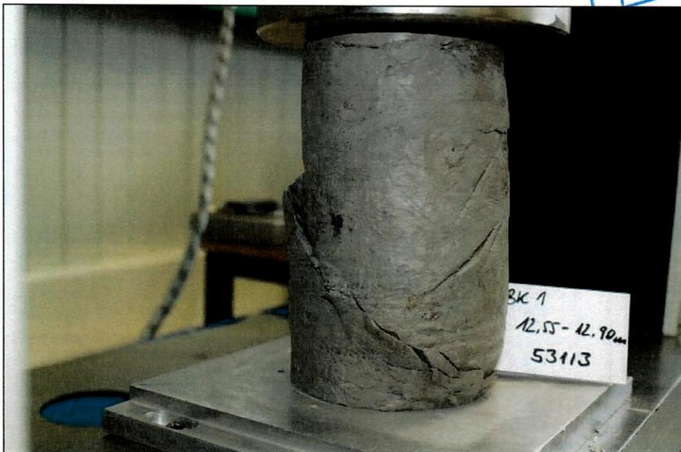
Bild 10: Bruchzustand Prüfkörper 531/3
