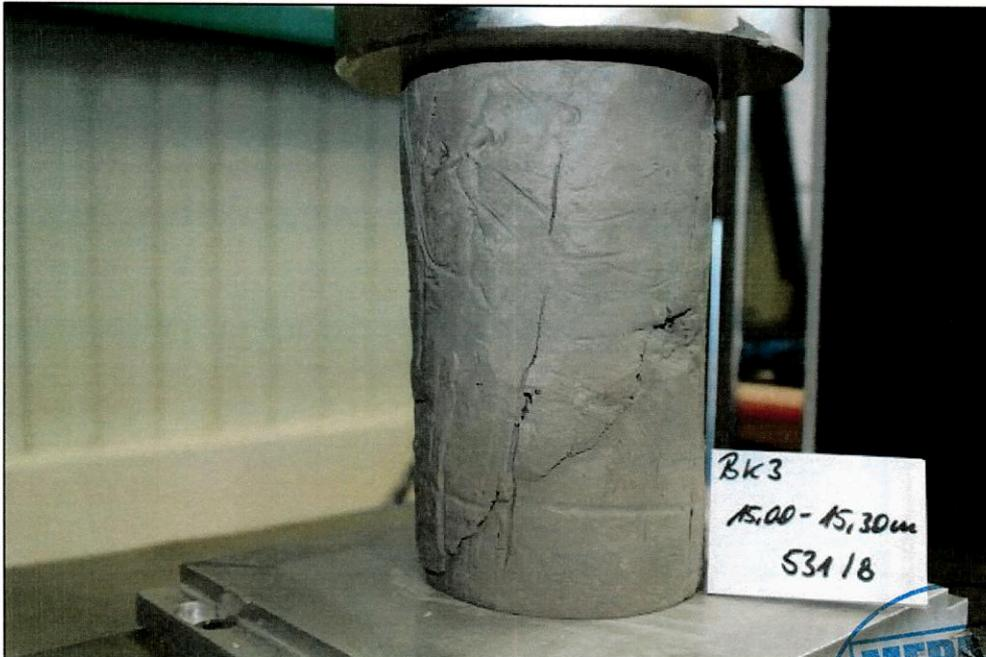
Bild 18: Bruchzustand Prüfkörper 531/8
