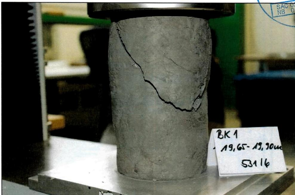
Bild 15: Bruchzustand Prüfkörper 531/6
