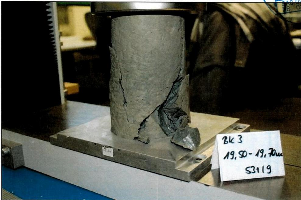
Bild 21: Bruchzustand Prüfkörper 531/9
