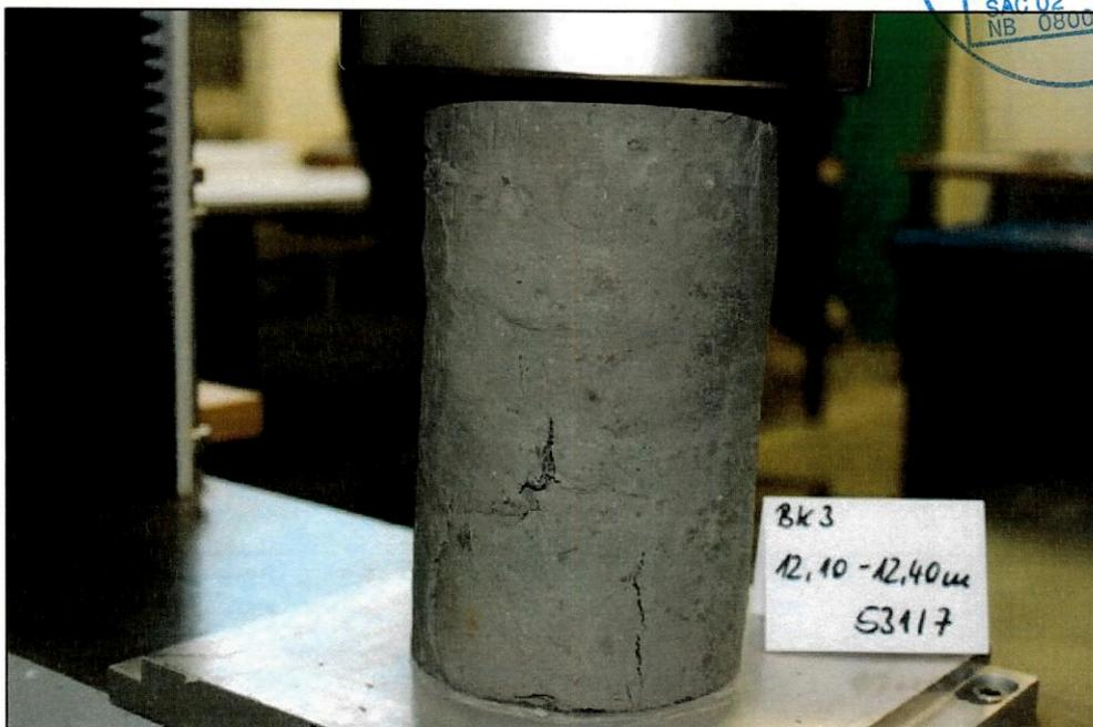
Bild 17: Bruchzustand Prüfkörper 531/7
