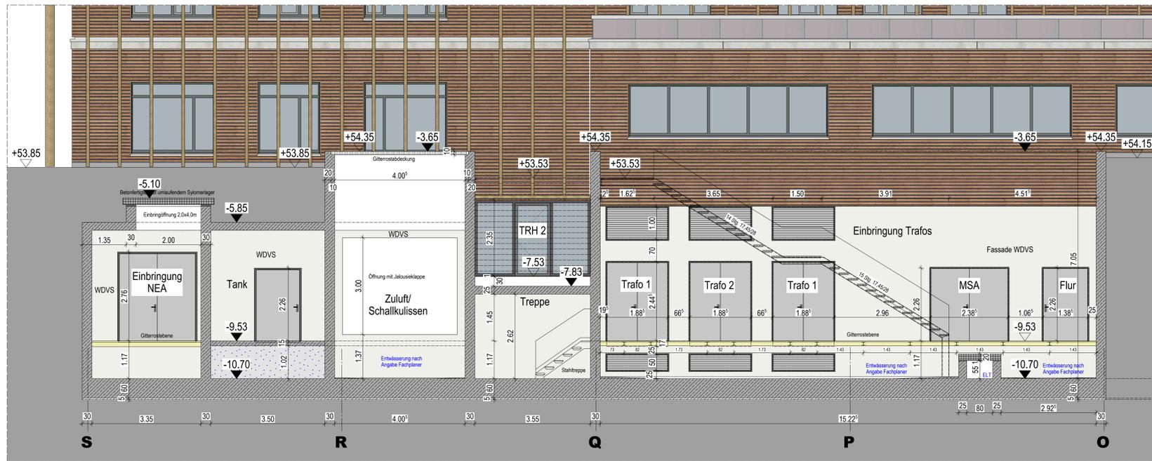
SC\_O1 - Längsschnitt Außenbauwerk UG Achse 1/O-S
