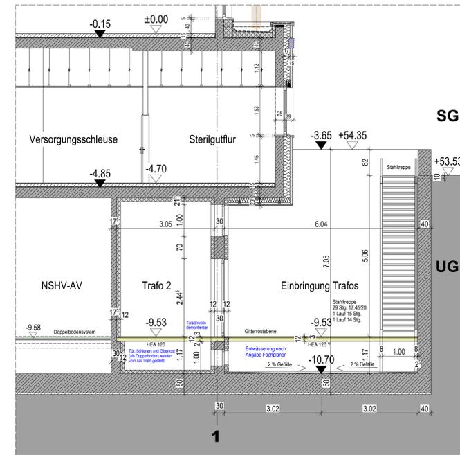
SC\_P1 - Fassadenschnitt Außenbauwerk UG Achse 1/P-Q
