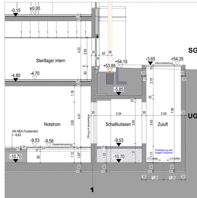
SC\_R1 - Fassadenschnitt Außenbauwerk UG Achse 1/R
