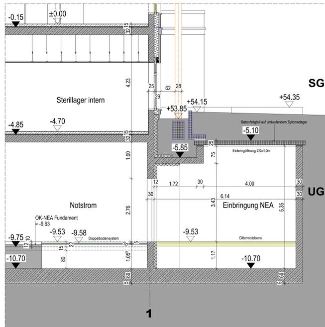
SC\_S1 - Fassadenschnitt Außenbauwerk UG Achse 1/R-S
