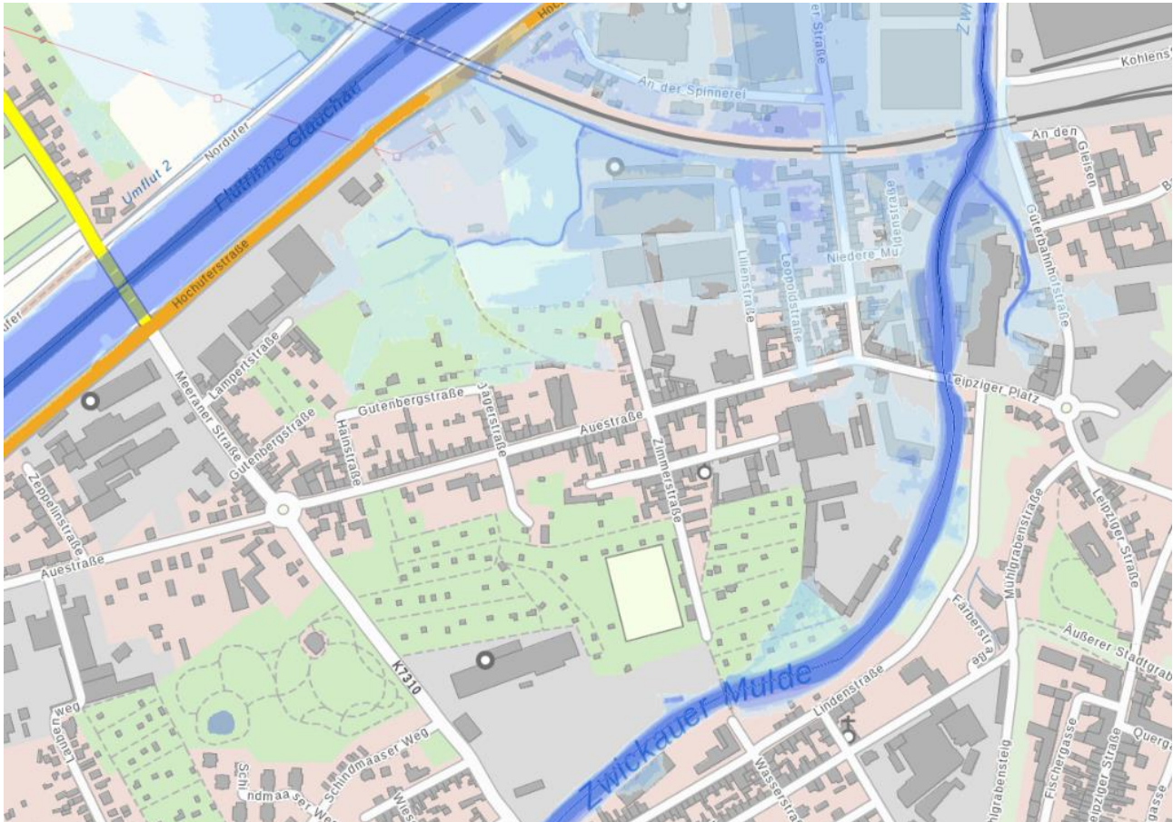
Abbildung 13 Überschwemmungsgebiete (HQ 100) im Untersuchungsgebiet „Auestraße“ (in Blau)
