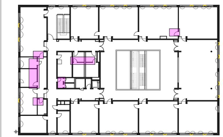
T30 RS ss = Tür feuerhemmend, rauchdicht und selbstschließend
