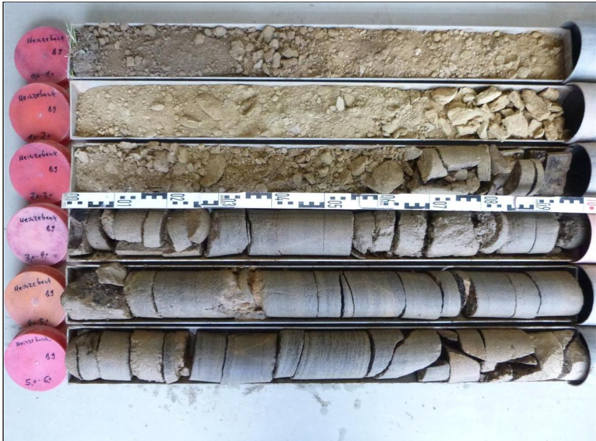
**Rotationskernbohrung (KB) 9 – Ansicht Bohrkern**
