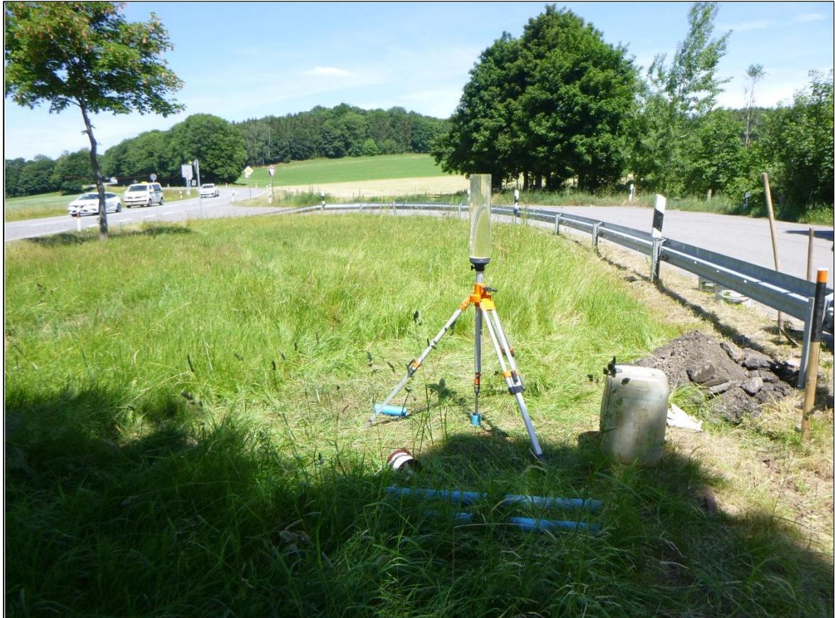
**Versickerungsversuch Rammkernsondierung (RKS-V) 14 – Ansatzpunkt**
