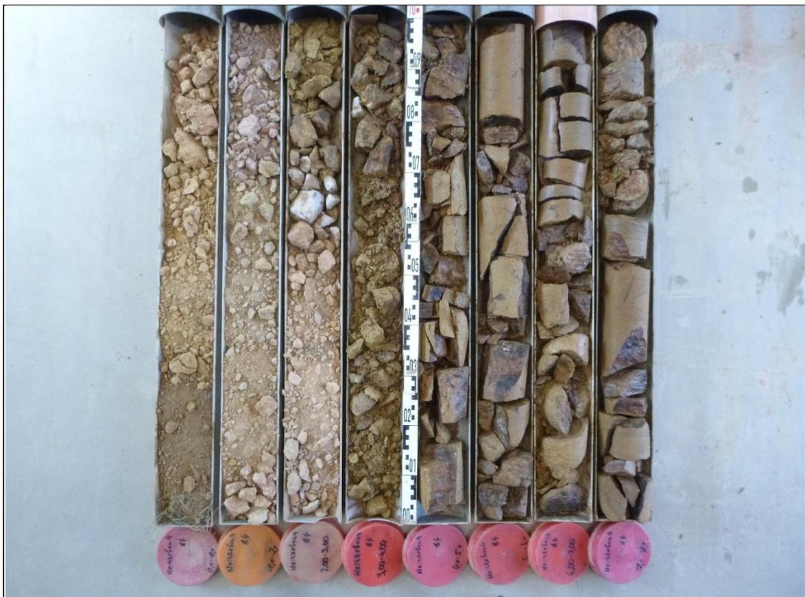
**Rotationskernbohrung (KB) 4 – Ansicht Bohrkern**
