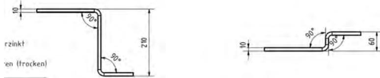
Aufgrund der Steifigkeitsverhältnisse kann davon ausgegangen werden, dass die Lasche mit der kurzen Steglänge die vollen Eigengewichtslasten überträgt.
