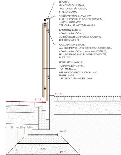
QUERSCHNITT MIT GEÖFFNETEM TOR, M 1:20
