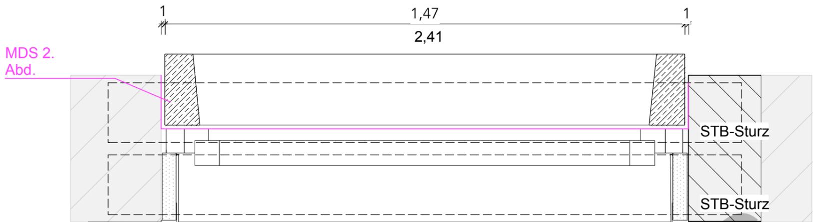
4cm Kalziumsilikatplatte, gespachtelt/überputzt inkl. Gewebeeckwinkel & Apuleiste, sofern Putz i. Bestand Spachtel ausziehen, schleifen an Laibungsecke
