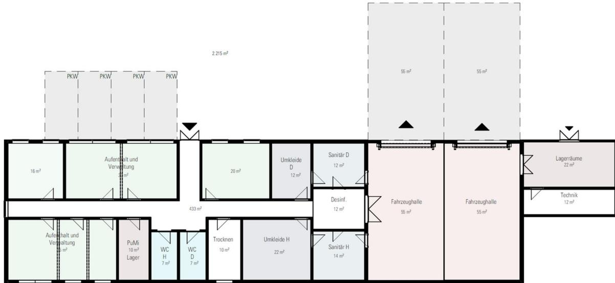
Abb.3 Eisfeld, Grundriss Vorentwurfsvariante 1, ohne Maßstab (maßstäbliche Darstellung gemäß Anlage 2)
