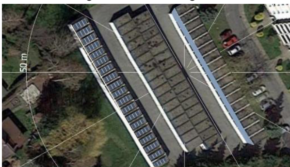
Abb. 12 Luftansicht der potenziellen Belegung der PV-Anlagen auf den Dachflächen der Objekte und den Fassaden der Wohnblöcke
